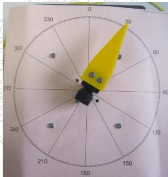
ภาพที่ 4.3 แกนหมุนสำหรับทดสอบทรานสดิวเซอร์
