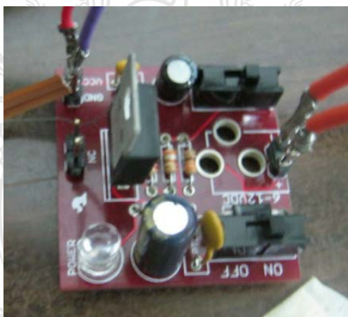
ภาพที่ 3.14 แหล่งจ่ายภายนอก (Power Supply)
