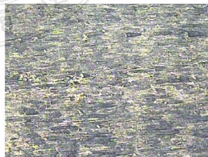
รูปที่ 8 ความเรียบผิวกัดด้านข้างแบบ Down -cut
