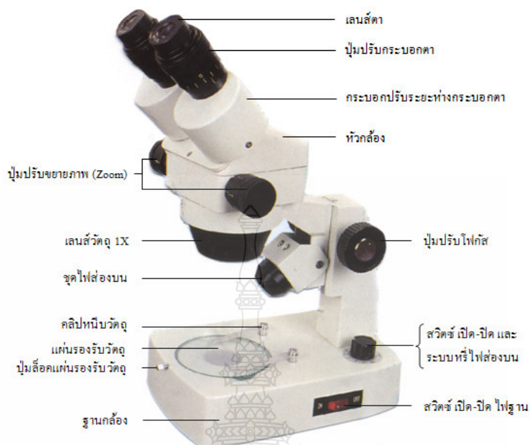
ภาพที่ 2.17 ส่วนประกอบของกล้องจุลทรรศน์ใช้แสงแบบสเตอริโอ [14]
