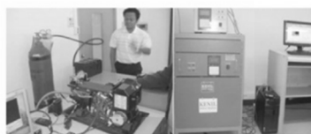
รูปที่ 4 ชุดทดสอบเซลล์เชื้อเพลิง ในห้องปฏิบัติการ
