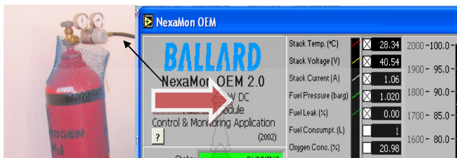
ภาพที่ 3.6 การปรับแรงดันก๊าซที่ถังโดยสังเกตค่าแรงดันที่โปรแกรม BALLARD Nexa Mon OEM 2.0
