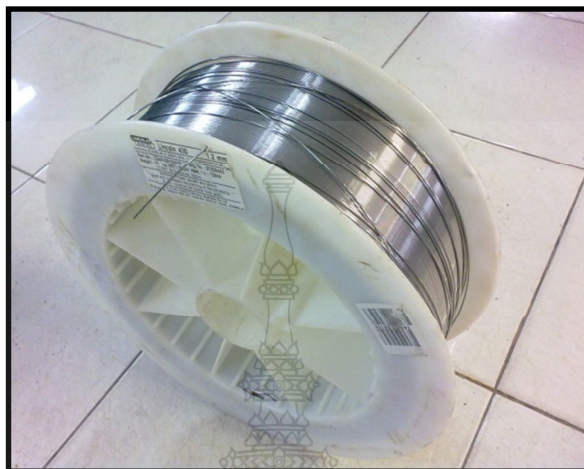
ภาพที่ 3.3 ลวดเชื่อมมิก ตามมาตรฐาน AWS A 5.9 ขนาด 1.2 มม.
