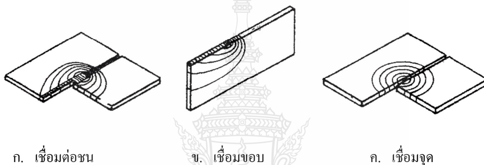
ภาพที่ 2.12 การกระจายอุณหภูมิของการเชื่อมงานแผ่นบาง [14]
