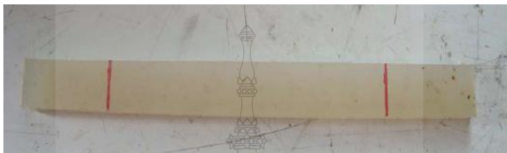
รูปที่ 3.25 ชิ้นงานสำหรับทดสอบการหน่วงไฟของวัสดุ
