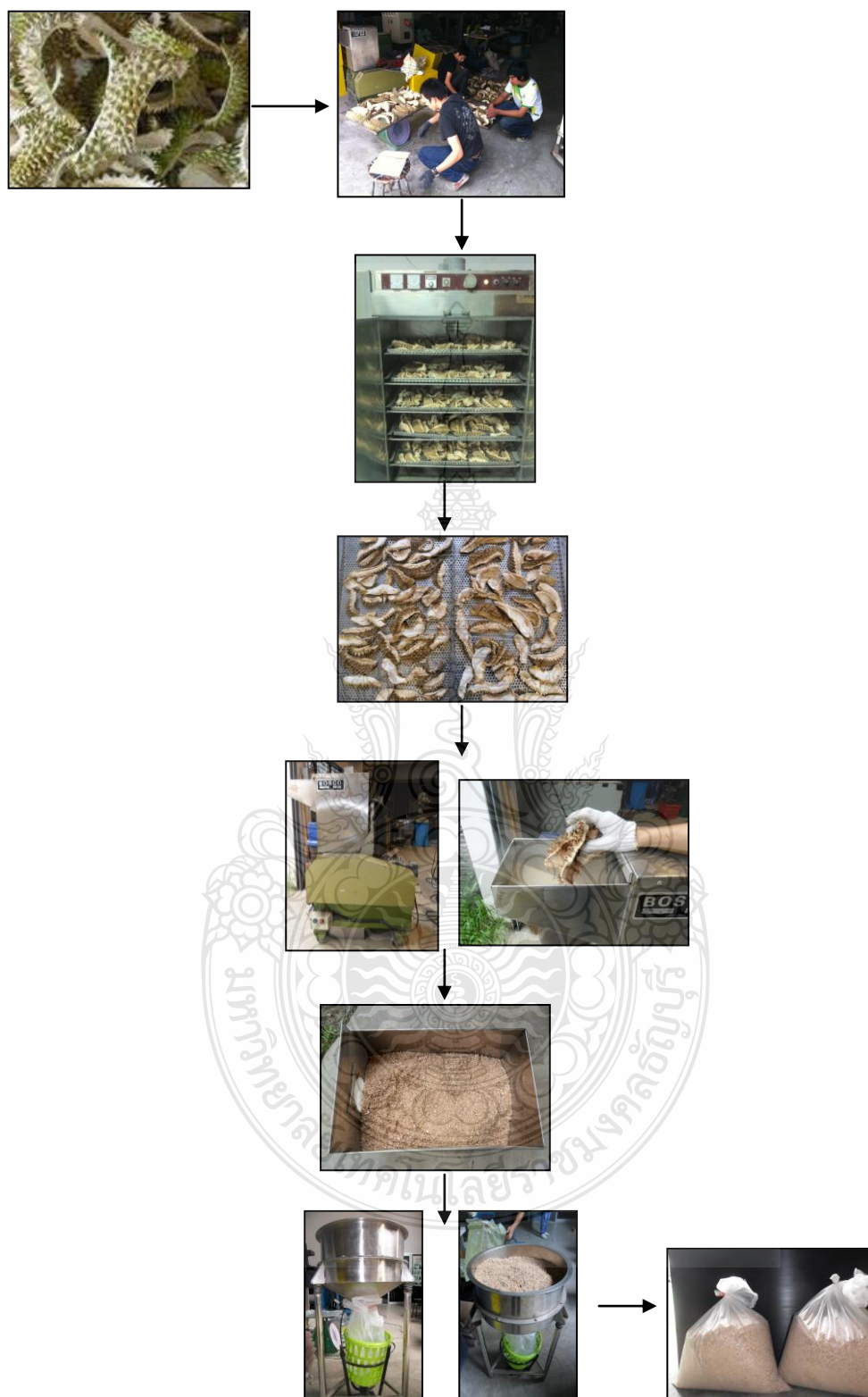
ภาพที่ 3.8 กระบวนการเตรียมผงเปลือกทุเรียนหมอนทองและเส้นใยเปลือกทุเรียนหมอนทอง [26]
