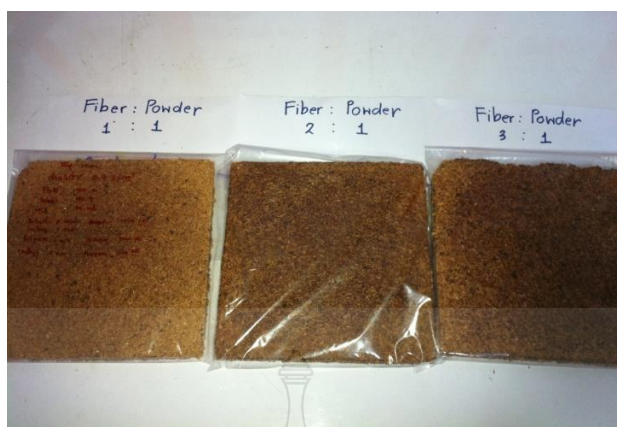
ภาพที่ 3.11 แผ่นชิ้นไม้อัดจากเปลือกทุเรียนหมอนทอง [26]
