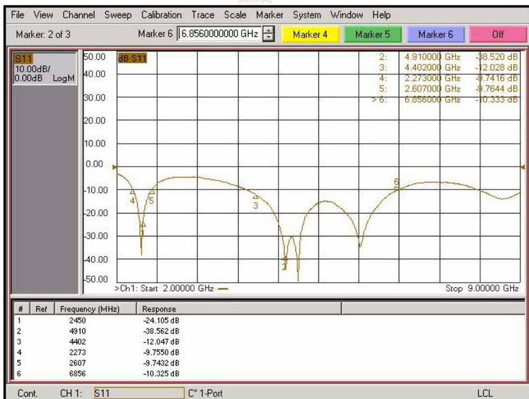
รูปที่ 4.2 ผลการวัดการสูญเสียย้อนกลับ ( S_{11} ) ของสายอากาศแบบช่องเปิดรูปอักษรอีบน FR4
