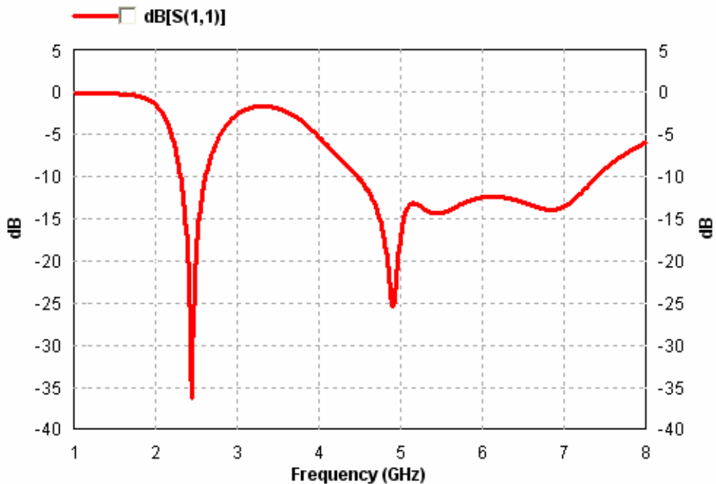
รูปที่ 3.36 คุณลักษณะของการสูญเสียจากการย้อนกลับ ( S_{11} ) ของสายอากาศ ไมโครสตริปแบบช่องเปิดรูปอักษรอินบน FR4
