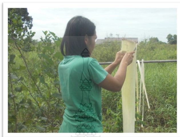
ภาพที่ 3.4 ลักษณะการวางตำแหน่งของกาบกล้วยขณะกรีด
