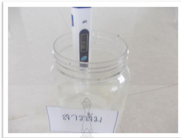
ภาพที่ 3.13 การวัดความเป็นกรด ค่างของสารฟอกขาวสารส้ม
