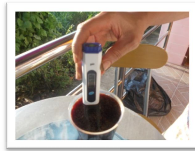
จ) การนำเชือกกล้วยขึ้นจากการข้อมสี ภาพที่ 3.18 ขั้นตอนการมัดข้อมผลิตภัณฑ์จากเชือกกล้วย ข) การวัดค่าความเป็นกรดต่างของสีข้อม
