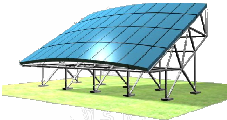
รูปที่ 3.12 ลักษณะ โครงสร้างที่ดำเนินการติดตั้งแผงเซลล์แสงอาทิตย์
