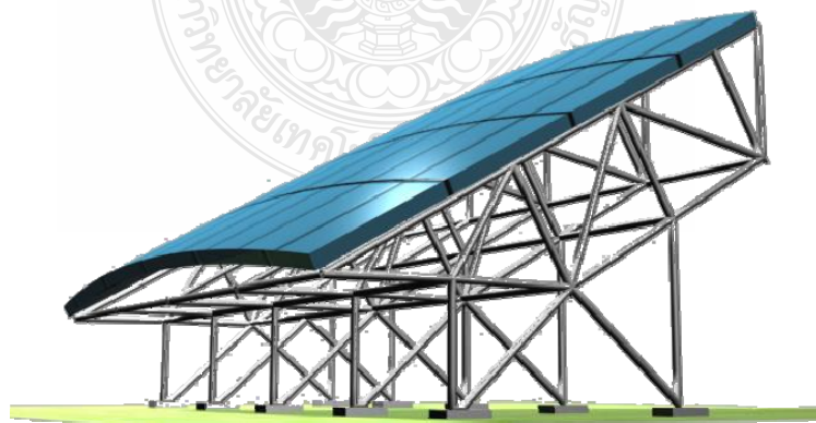
รูปที่ 3.13 ลักษณะ โครงสร้างแผงเซลล์แสงอาทิตย์ที่นำมาออกแบบ
