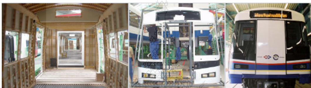
ภาพที่ 2.13 โครงสร้างรถไฟฟ้า MRT ที่ผลิตจากวัสดุวิศวกรรม [7]
