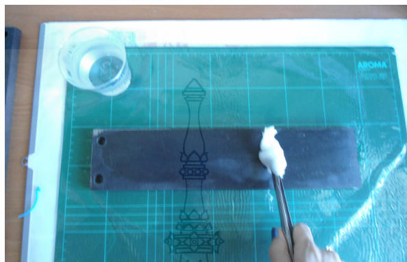
ภาพที่ 3.7 ทำความสะอาดชิ้นงานด้วยสารละลายอะซิโตน
