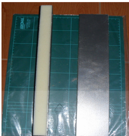
ภาพที่ 3.15 ชิ้นทดสอบที่ประกอบเป็น โครงสร้างวัสดุแกนวิช ตามมาตรฐาน ASTM C393
