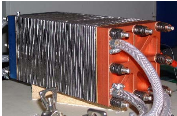
รูปที่ 2.2 ต้นแบบของเซลล์เชื้อเพลิง PEMFC ที่ใช้ทำการทดลองมีพิกัด 2kW, 300A, 7V ออกแบบและพัฒนาโดย French Atomic Energy Center (CEA)
