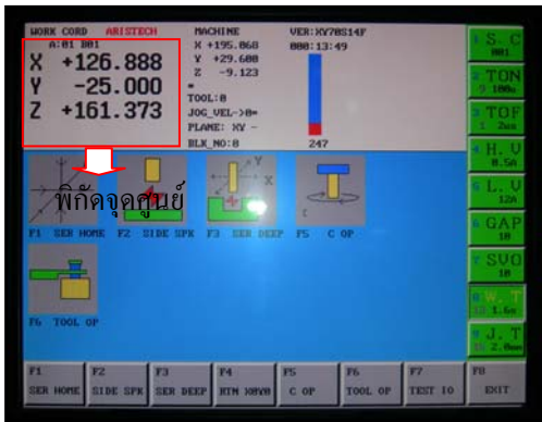
(ก) พิกัดแสดงค่าศูนย์ของอเล็กโตรด (ข) ค่าที่อ่านได้จากหน้าปัดนาฬิกาวัดเท่ากับ 0.01 มม.
