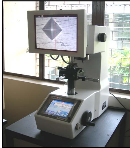
รูปที่ 3.13 เครื่องทดสอบความแข็งไมโครวิกเกอร์ Matsuzawa รุ่น MMT-X7
