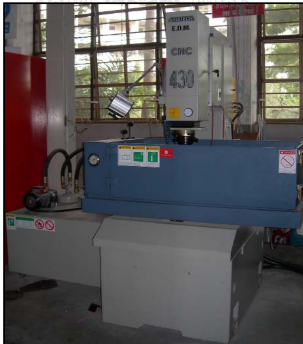
รูปที่ 3.5 เครื่องกัดเซาะโลหะด้วยกระแสไฟฟ้ายี่ห้อ Aristech รุ่น 3D-CNC EDM
