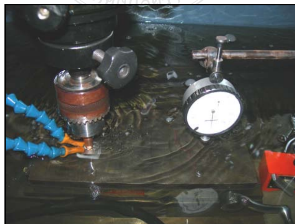
รูปที่ 3.10 การสปาร์กชิ้นงานเหล็กกล้า AISI P20
