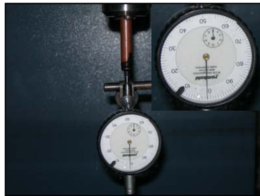
(ก) พิกัดแสดงค่าศูนย์ของอเล็กโตรด (ข) ค่าที่อ่านได้จากหน้าปัดนาฬิกาวัดเท่ากับ 0.01 มม.
