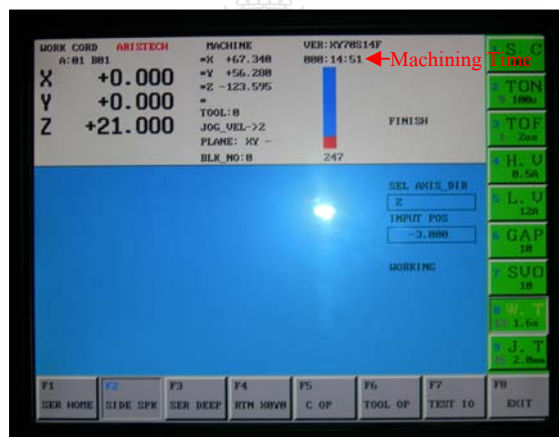
รูปที่ 3.6 หน้าจอแสดงเวลารวมในการทำงาน (Machining Time)
