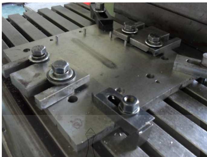
รูปที่3.6 รูปแบบของอุปกรณ์จับยึดชิ้นทดสอบ FSW
