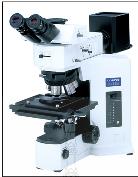
รูปที่ 3.11 กล้องตรวจสอบโครงสร้างจุลภาค
