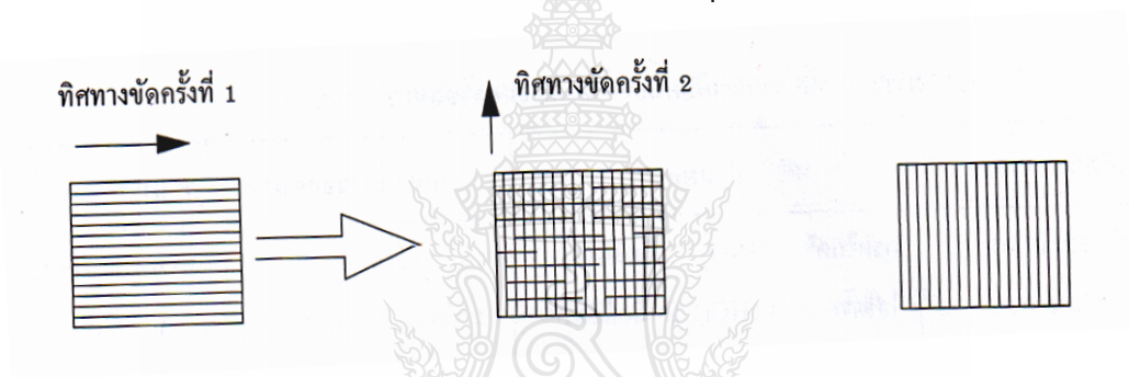
รูปที่ 2.9 ลักษณะแนวทางการขัดชิ้นงานตรวจสอบเป็นตาราง [14]
