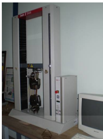
รูปที่ 3.8 ลักษณะเครื่องทดสอบแรงดึง
