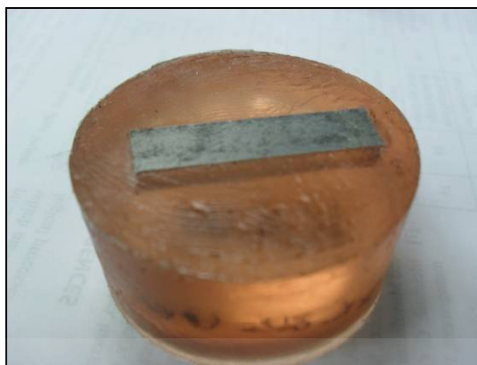
รูปที่ 3.9 การเตรียมชิ้นทดสอบโครงสร้างจุลภาค
