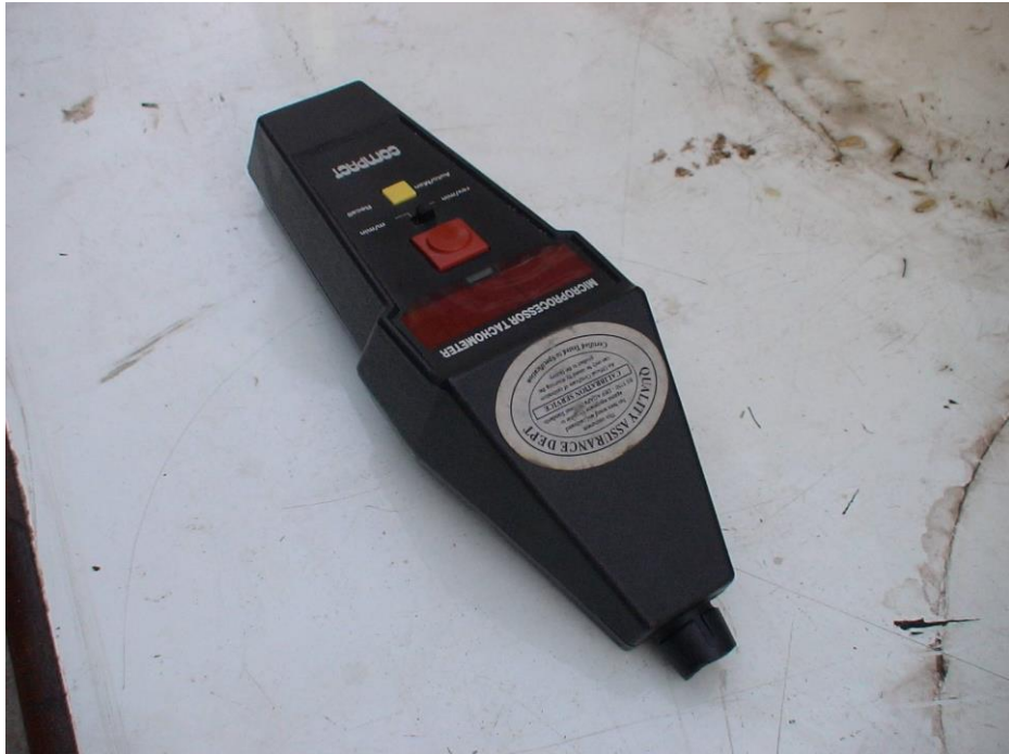
ภาพผนวกที่ ค.8 แสดงเครื่องมือวัดความเร็วรอบของเครื่องยนต์
