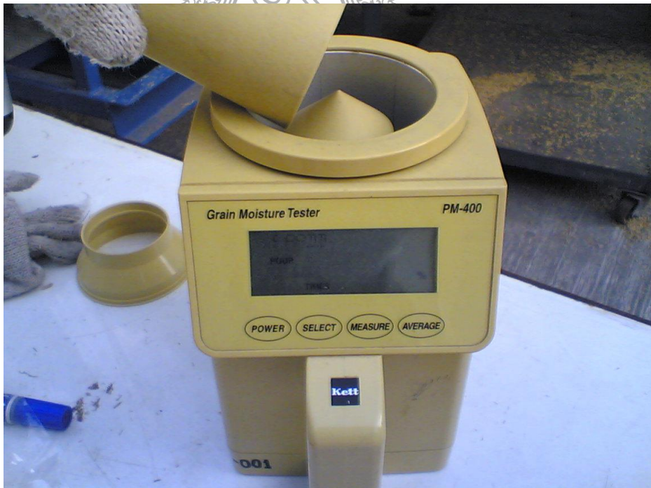
ภาพผนวกที่ ค.9 การวัดความชื้นข้าวเปลือกก่อนการอบแห้ง
