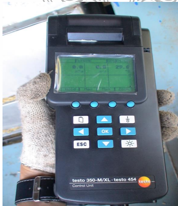
ภาพผนวกที่ ค.7 แสดงการตรวจเช็คอุณหภูมิลมร้อนและความเร็วลมก่อนเข้าห้องอบ
