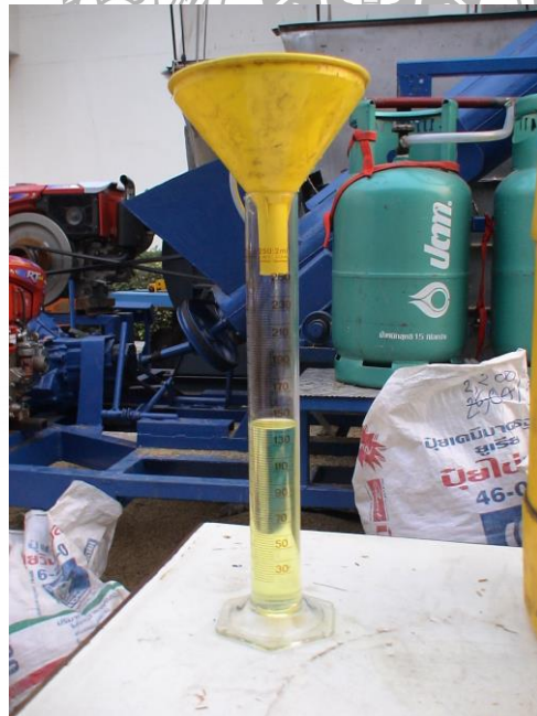
ภาพผนวกที่ ค.14 การวัดปริมาณการใช้น้ำมัน
