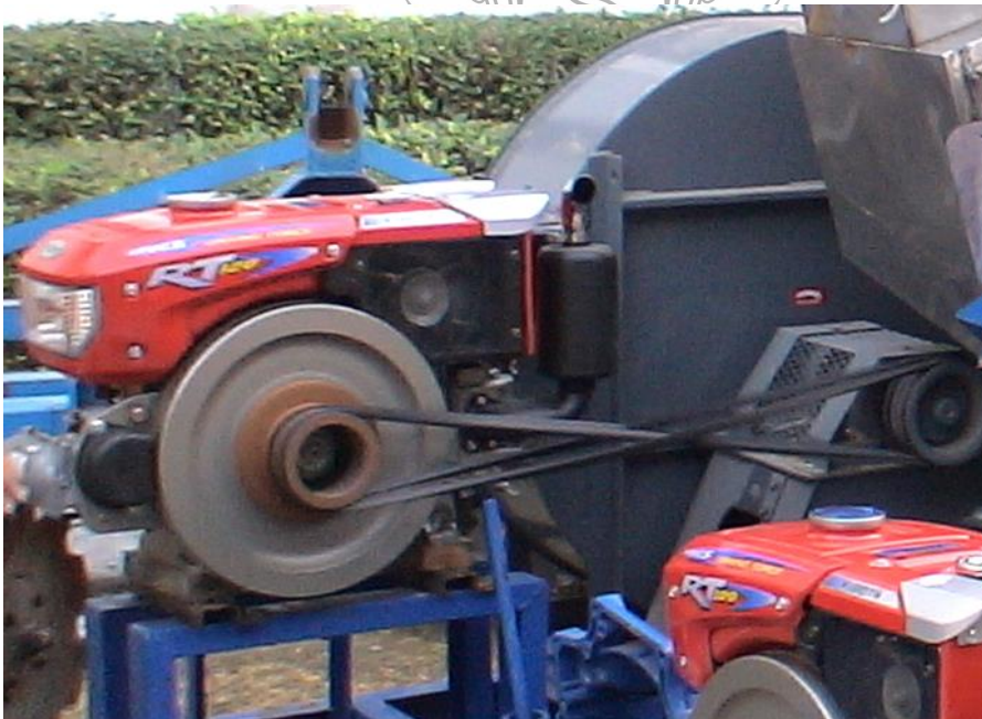
ภาพที่ 4.2 ลักษณะการส่งกำลังจากเครื่องยนต์ไปยังพัดลม
