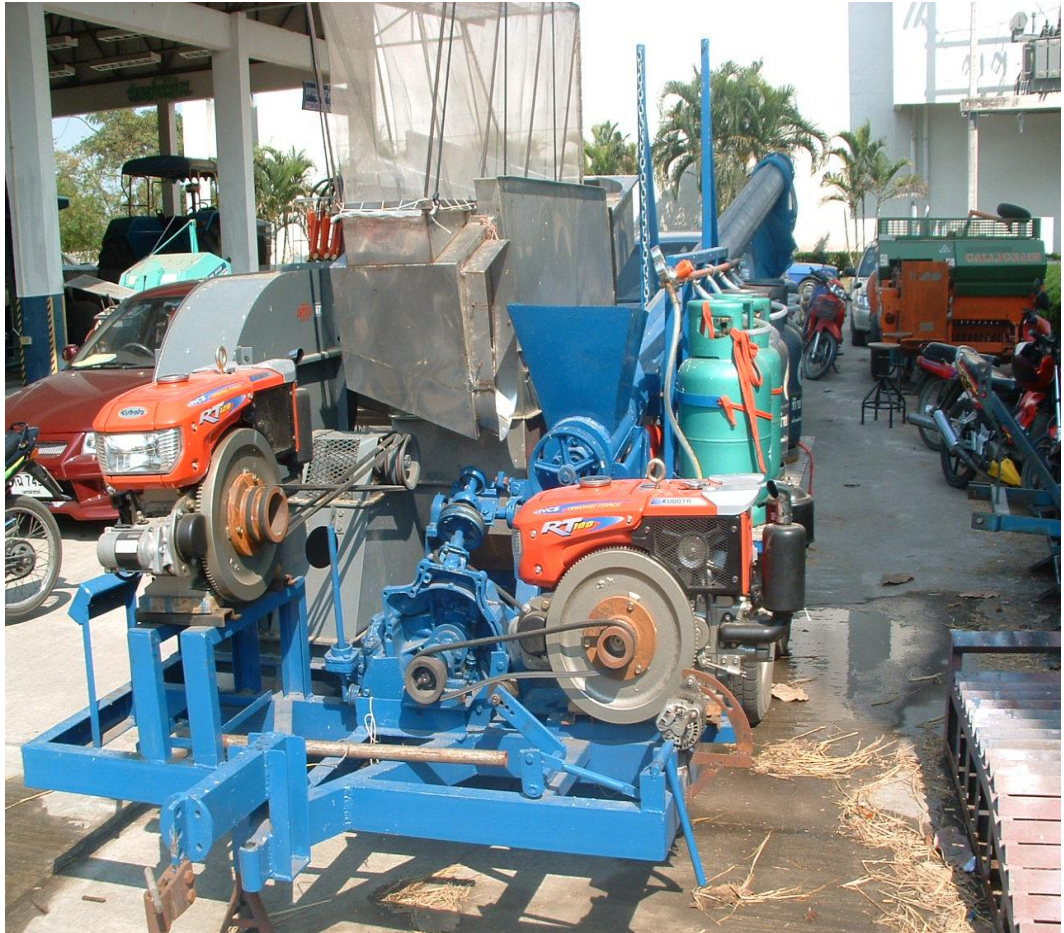
ภาพผนวกที่ ค.1 แสดงลักษณะภายนอกของเครื่องอบแห้งข้าวเปลือกแบบไหลต่อเนื่อง
