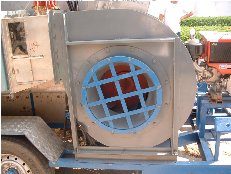
ภาพผนวกที่ ค.5 แสดงลักษณะการติดตั้งพัดลมเข้ากับห้องเผาไหม้
