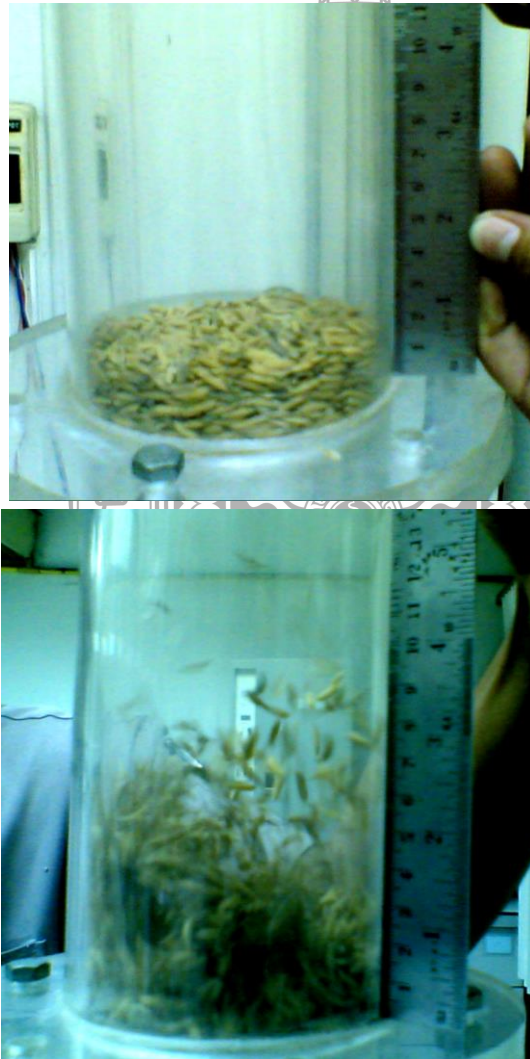
ภาพที่ 3.2 การทดสอบการลอยตัวของข้าวเปลือก
