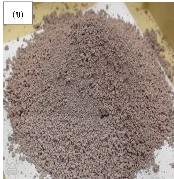
รูปที่ 4.5 ตัวอย่างชิ้นงานทดสอบที่ผ่านการอัดขึ้นรูปด้วยความดันที่ 300 \text{ kg/cm}^2 ของ Mesh No.40: (ก) ตัวอย่างชิ้นงานทดสอบที่เสียหาย แตกร้าวบริเวณผิวหน้าตัดของชิ้นงาน และ (ข) การพังทลายของ ตัวอย่างชิ้นงานทดสอบ
