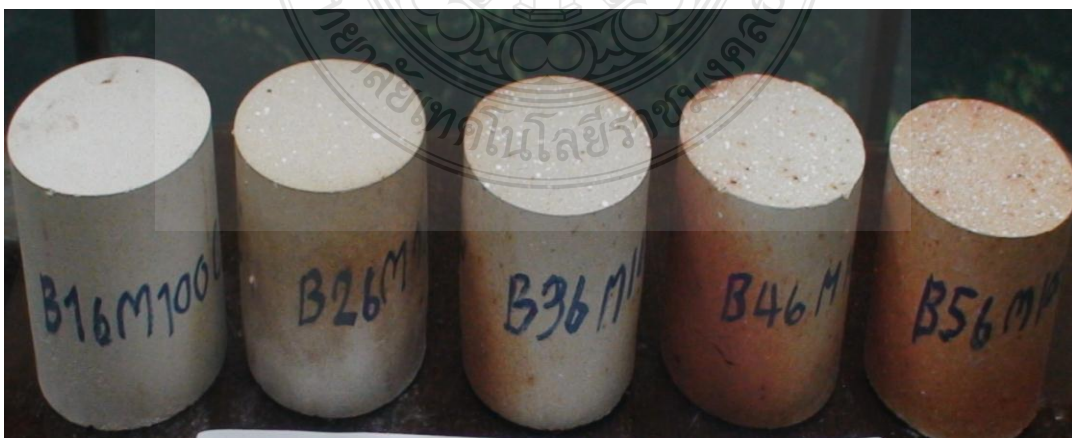
รูปที่ 4.3 ตัวอย่างชิ้นงานของเถ้าลอยอะลูมิเนียมหลังการเผาอุณหภูมิที่ 1,200 °C
