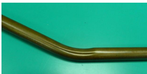
รูปที่ 4.3 บริเวณส่วนโค้งอลูมิเนียมท่อกกลางที่เกิดรอยบุบ
