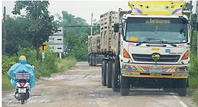
รูปที่ 1.1 สาเหตุความเสียหายของผิวทางที่เกิดจากรถบรรทุก [5]
