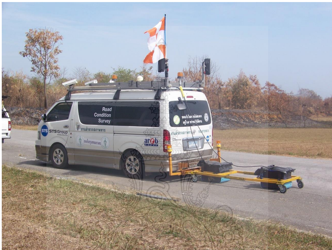
รูปที่ 3.2 เครื่องมือ Ground Penetrating Radar (GPR)
