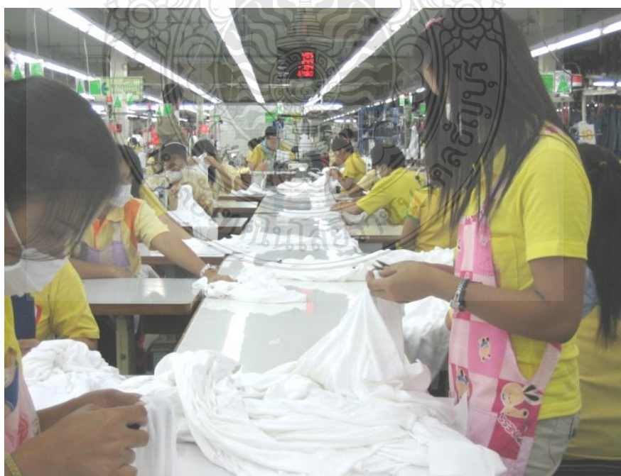
รูปที่ 3.32 ภาพแสดงระบบการผลิตแบบไหลทีละชิ้น (หลังปรับปรุง)
