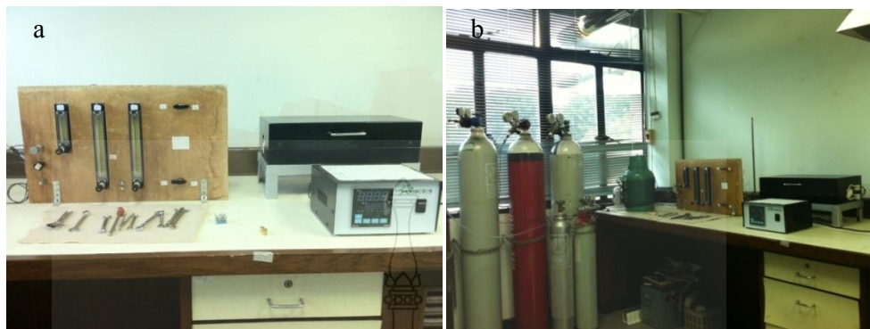
ภาพที่ 4.2 ชุดควบคุมทิศทางและอัตราการไหลของแก๊สที่ติดตั้งเข้ากับเตาให้ความร้อน (a) และระบบสังเคราะห์ท่อนาโนคาร์บอนแบบประกอบตัวขึ้นเองด้วยวิธีตกสะสมไอสารเคมีที่ติดตั้งเสร็จแล้ว (b)
