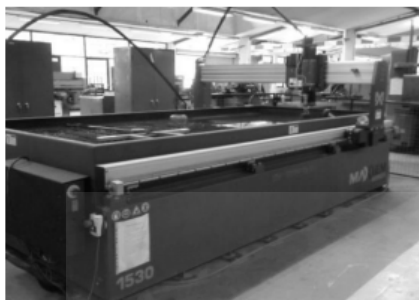
รูปที่ 2 แสดงลักษณะของเครื่องตัดวัสดุด้วยน้ำแรงดันสูง
