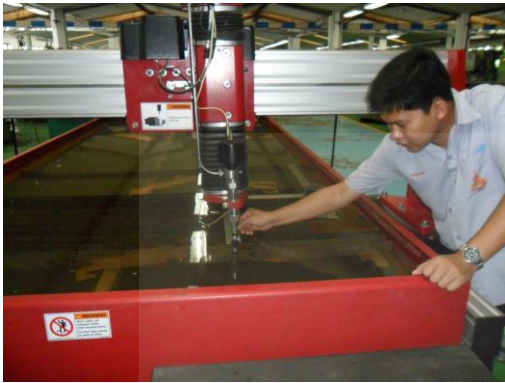
รูปที่ 3.20 ลักษณะการตั้งความสูงหัวตัด
