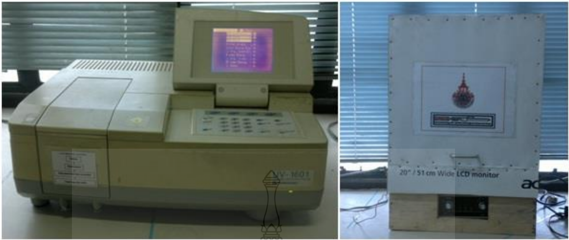
รูปที่ 3.23 รูปเครื่อง UV Spectrophotometer (UV-1601 SHIMADZU)และตู้ที่บแสง
