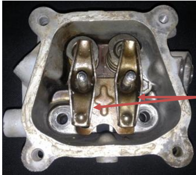
รูปที่ 3.9 กลไกการปิดเปิดวาล์ว
