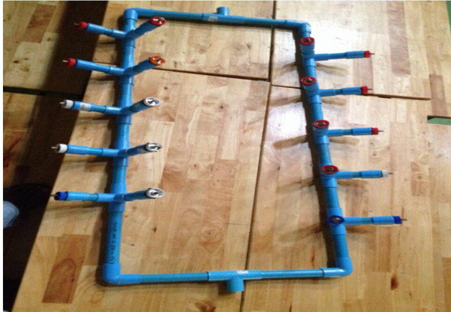
รูปที่ 3.28 ประกอบท่อลมหลัก 2 ท่อน ถอดสรเติมลมรถจักรยานยนต์ออกใช้ในการเติมลมเข้า
