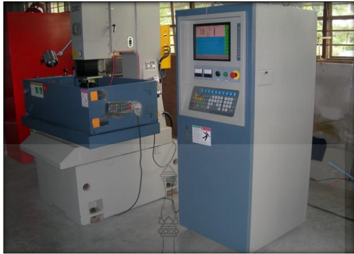
รูปที่ 3.5 เครื่องกัดเซาะ โลหะด้วยไฟฟ้าที่ใช้ในการทดลอง Aristech รุ่น 3D-CNC EDM
