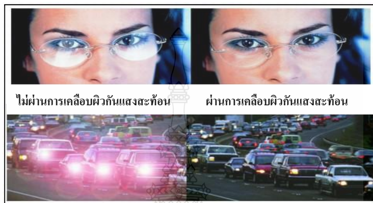
ภาพที่ 2.15 เปรียบเทียบเลนส์ที่ผ่านการเคลือบ และไม่เคลือบกันแสงสะท้อน
