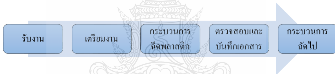
ภาพที่ 3.1 แสดงขั้นตอนภายในกระบวนการฉีดพลาสติก
