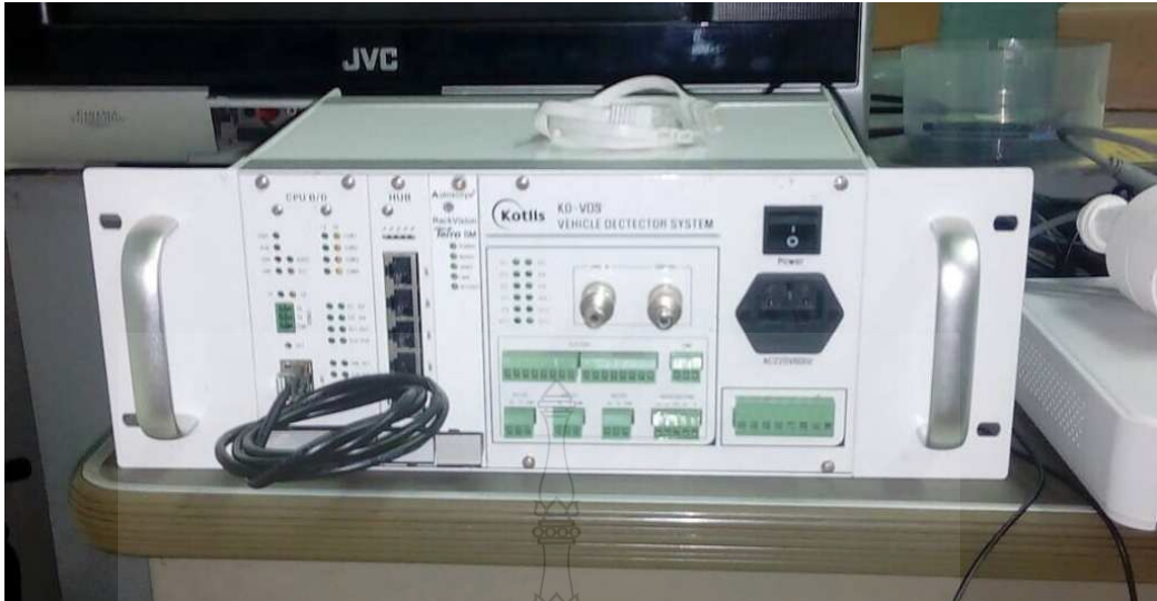
รูปที่ 3.2 เครื่องประมวลผลภาพจากกล้องวิดีโอสำหรับนับรถภาคสนาม
