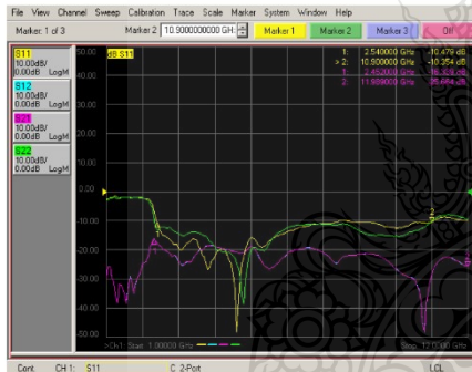
รูปที่ 5 ผลการวัดค่าสัมประสิทธิ์การสะท้อนกลับ ( S_{11} , S_{22} ) และสัมประสิทธิ์การส่งผ่าน ( S_{21} , S_{12} )
