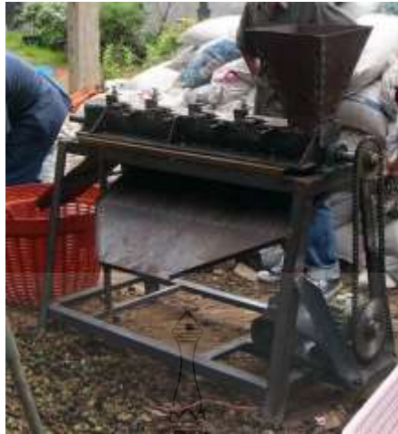
รูปที่ 2.37 ทดสอบและพัฒนาเครื่องกะเทาะเปลือกเขียวมะคาเดเมีย [29]
