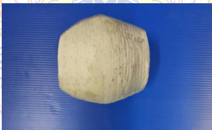
รูปที่ 4.10 ผลเปลือกที่ผ่านการปอกด้วยเครื่องที่ระดับความเร็วรอบต่ำ (8 รอบ/นาที)
