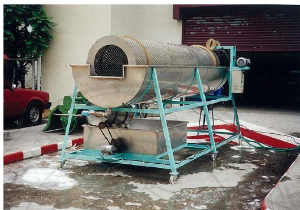
รูปที่ 2.15 เครื่องปอกเปลือกมันฝรั่งชนิดปรับรอบปอก [16]
