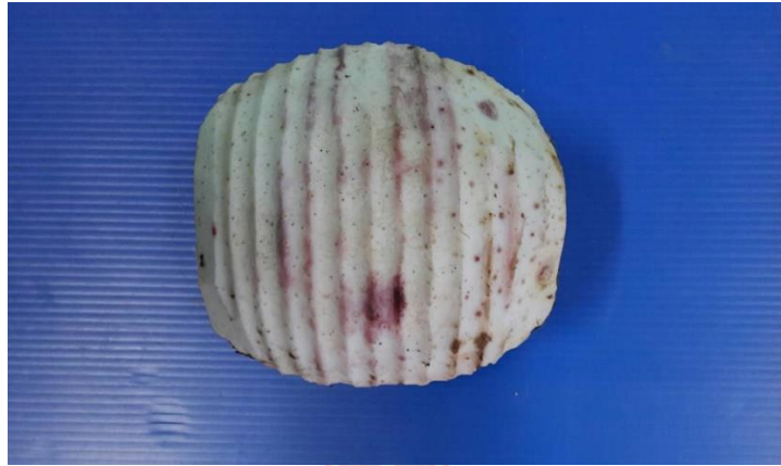
รูปที่ 4.11 ผลเผือกที่ผ่านการปอกด้วยเครื่องที่ระดับความเร็วรอบสูง (12, 16, 20 และ 24 รอบ/นาที)
