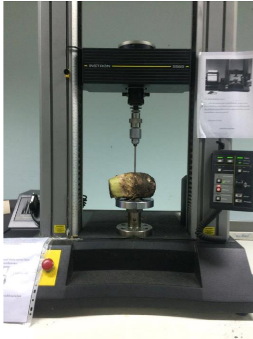
รูปที่ 4.4 การทดสอบสมบัติเชิงกลของเปลือก
