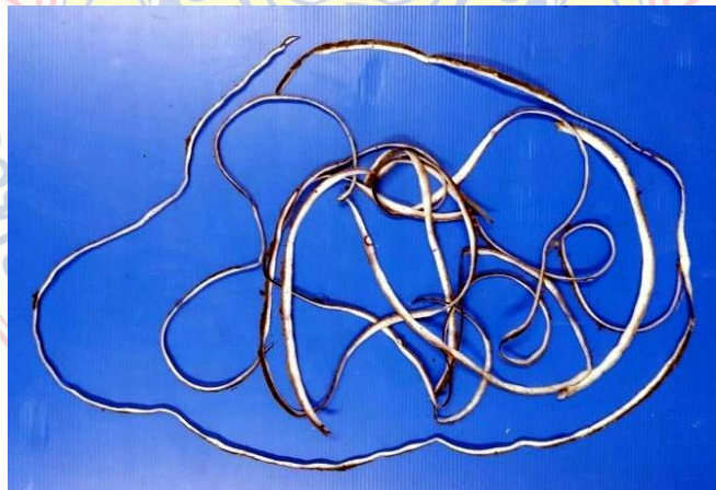
รูปที่ 4.13 เปลือกเผือกที่ได้จากการปอกด้วยเครื่อง
