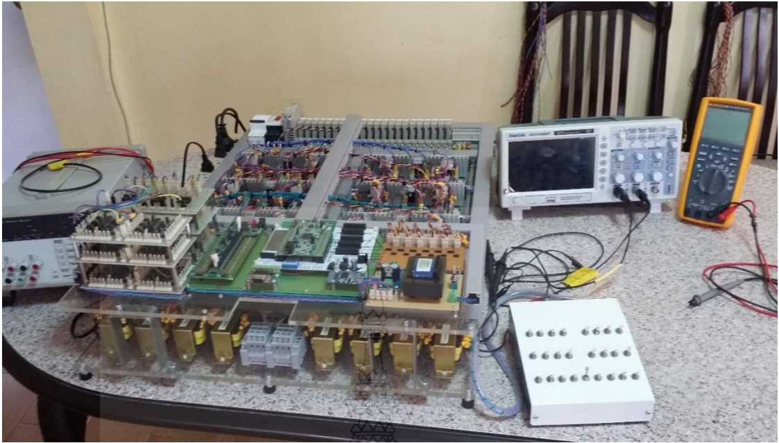
รูปที่ 3.42 วงจรการควบคุมแบบสภาวะคงทนของอินเวอร์เตอร์สามระดับขณะทำการทดสอบ
