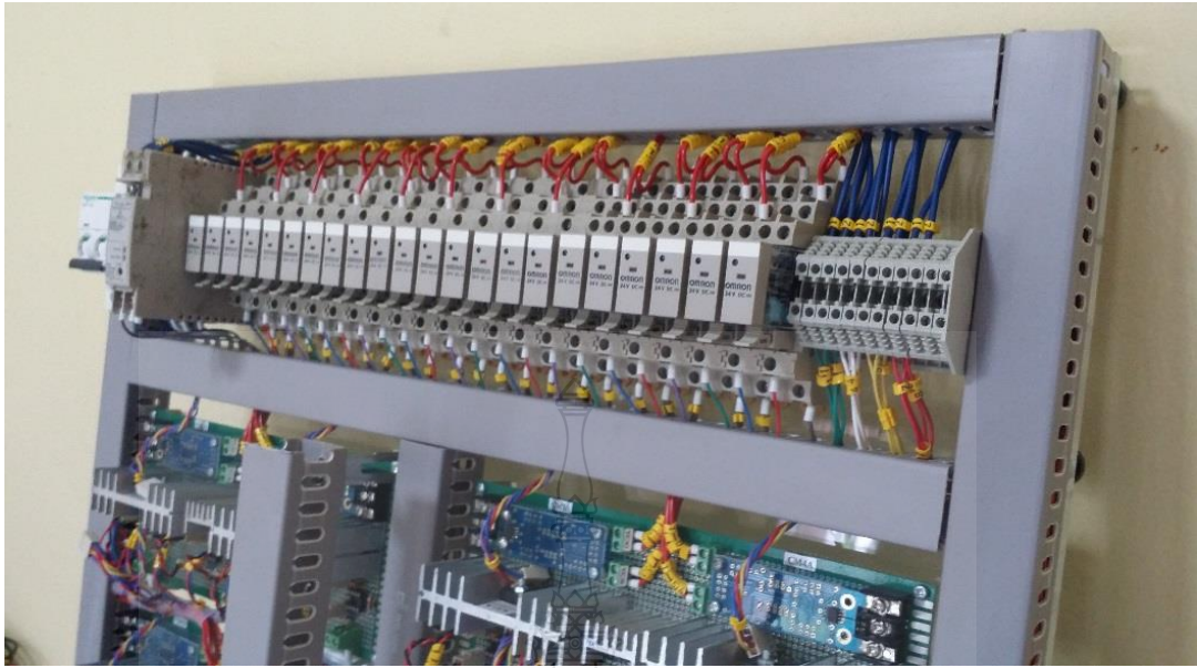
รูปที่ 3.39 รีเลย์ที่ใช้ในการจำลองการเกิดสภาวะลัดวงจรและสภาวะเปิดวงจร
