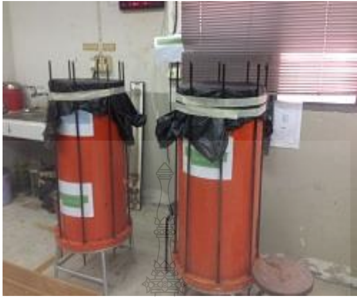
รูปที่ ง.15 การบ่มเสาเข็มดินซีเมนต์
