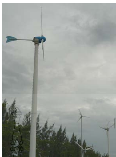
รูปที่ 1.2 กังหันลมหมุนแกนนอน(Horizontal Axis Wind Turbine,HAWT)
