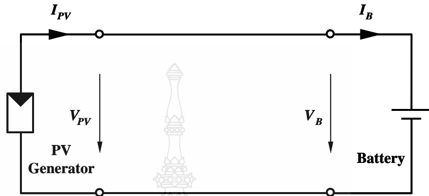
รูปที่ 2.47 การต่อเซลล์แสงอาทิตย์โดยตรงกับแบตเตอรี่
