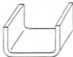
รูปที่ 2.11 ตัวอย่าง ของการดัดรูปตัวยู ในงานโลหะแผ่น
