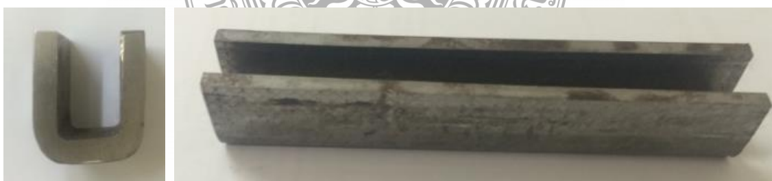
รูปที่ 3.20 ชิ้นงานหลังการตัดขึ้นรูปตัวยู
