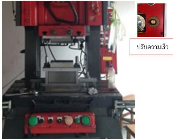
รูปที่ 3.17 การติดตั้งแม่พิมพ์บนเครื่องปั๊ม
