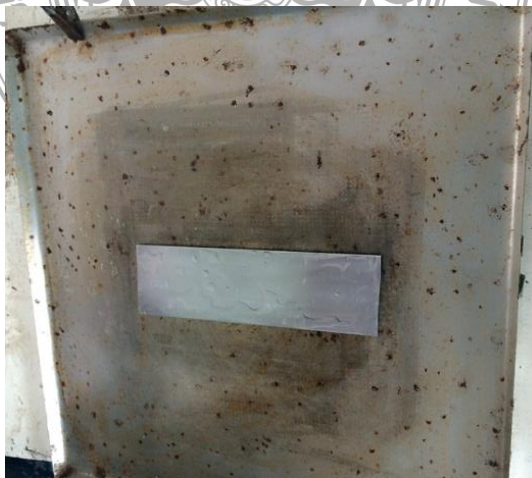
รูปที่ 3.11 ทำความสะอาดชิ้นงานด้วยอะซีโตน
