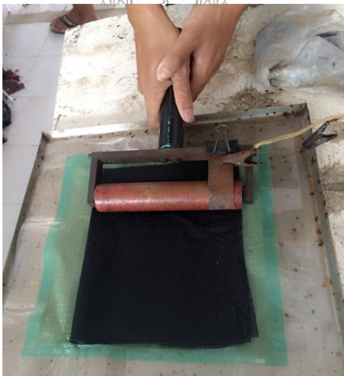
รูปที่ 3.13 การปล่อยกระแสไฟฟ้าผ่านแผ่นฟิล์มเพื่อทำการกัดผิวโลหะ
