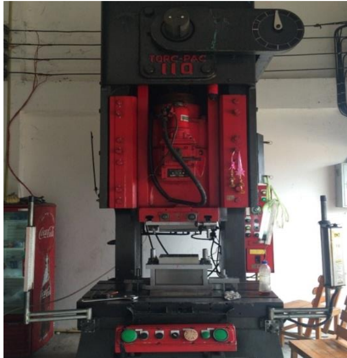
รูปที่ 3.2 เครื่องปั๊มไฮดรอลิกขนาด 110ตัน
