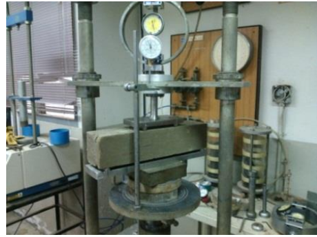
รูปที่ 7 การทดสอบแรงดัดแบบ Third point loading
