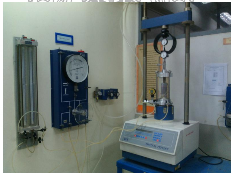
รูปที่ 3.4 ตัวอย่างที่พร้อมทำการทดสอบ Consolidated Undrained Triaxial Test
