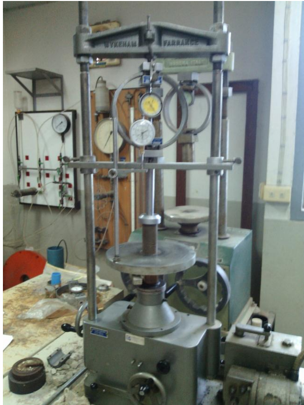
รูปที่ 3.3 ตัวอย่างที่พร้อมทำการทดสอบการรับแรงอัดทิศทางเดียว
