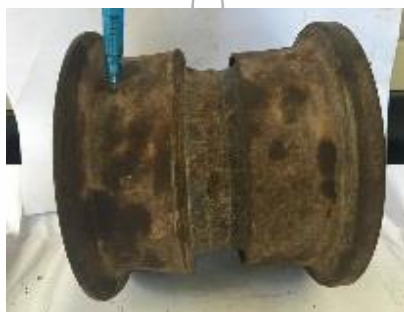
รูปที่ 4.10 ปัญหาการสึกหรอบนพื้นผิวของลูกโรลเลอร์ชำรุด
