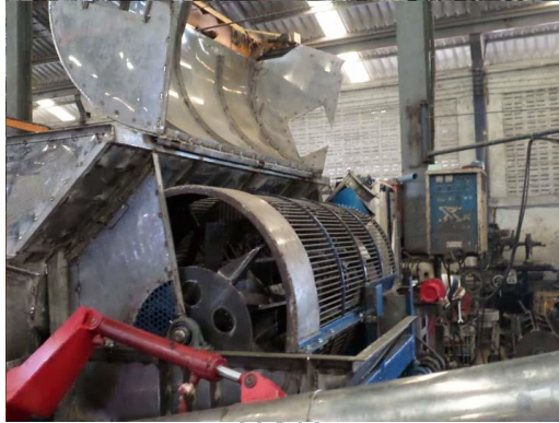
รูปที่ 2.13 หลักการทำงานของชุดนวดแบบไหลตามแกน
