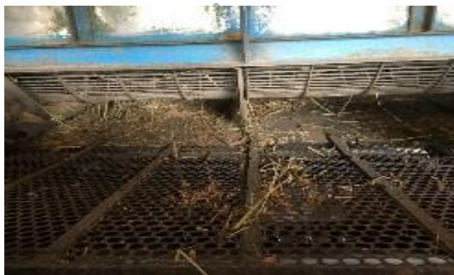
รูปที่ 4.6 ปัญหาตะแกรงร้อนเมล็ดข้าวชำรุด
