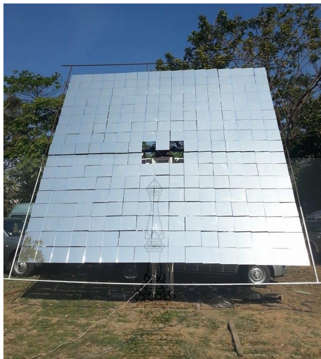
รูปที่ ข.5 แผงที่ติดตั้งกระจากสะท้อน
