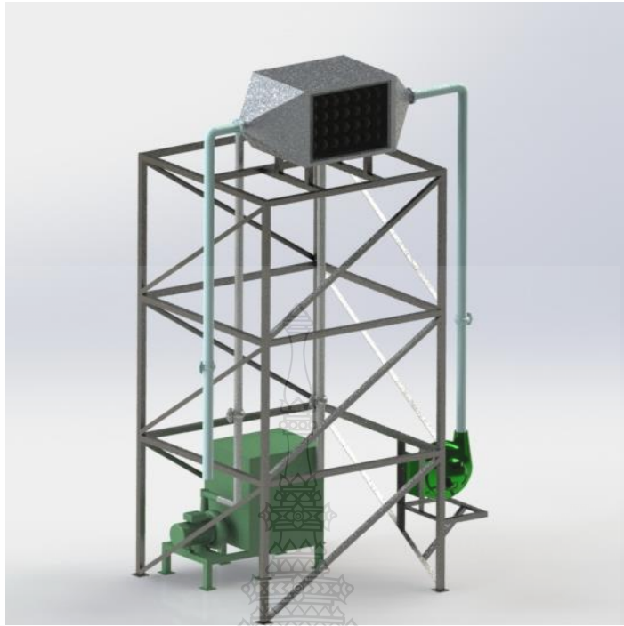
รูปที่ 3.5 ชุดอุปกรณ์ตัวเก็บความร้อนแสงอาทิตย์
