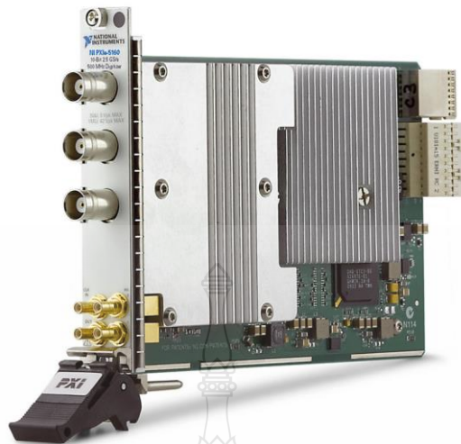
รูปที่ 3.18 ออสซิลโลสโคปรุ่น NI Pxl-5160 500MHz , Sample rate 2.5 GS/s , 10 Bits
