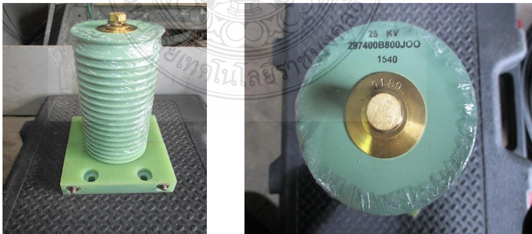
รูปที่ 2.12 PD Sensor ชนิด EMC ขนาด 80 pF [10]
