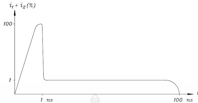
รูปที่ 2.4 ลักษณะกระแสการคายประจุบางส่วนทางทฤษฎีสำหรับช่องว่างอากาศ [7]
