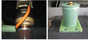
รูปที่ 3 High Volt Cable & Epoxy Mica Capacitors 80 pF
