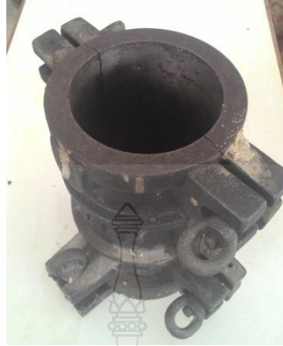
รูปที่ 3.3 แบบหล่อตัวอย่างคอนกรีต ขนาด \varnothing 10 \times 20 เซนติเมตร
