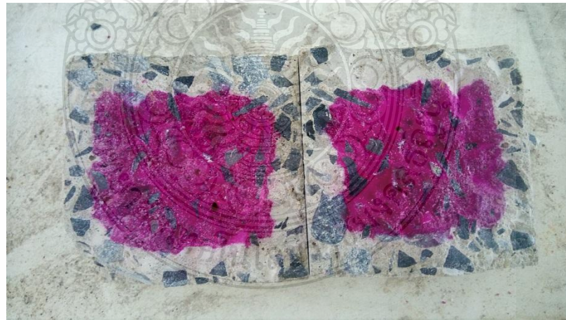
รูปที่ 4.27 ตัวอย่างของคอนกรีตที่ทดสอบการเกิดคาร์บอนชั้น โดยใช้น้ำยาฟีนอลทาฮีนในแอลกอฮอล์ชนิดลงบนผิวคอนกรีตที่เผชิญก๊าซคาร์บอนไดออกไซด์
