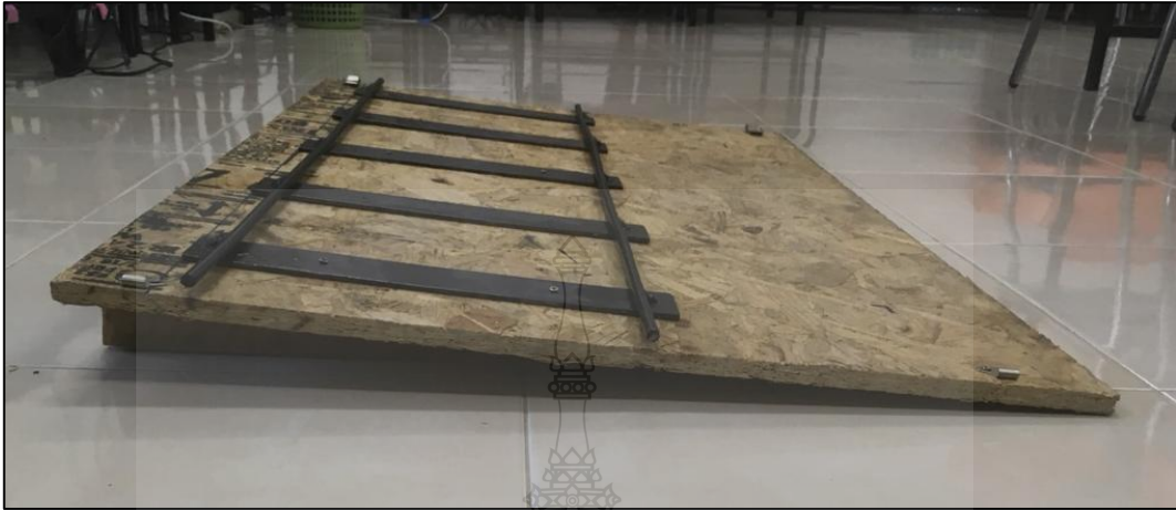
รูปที่ 3.16 การยกโค้งทางรถไฟจำลอง
