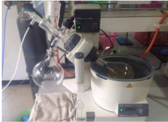
รูปที่ 3.4 การกำจัดน้ำและเมทานอลด้วยเครื่อง Rotary Evaporator
