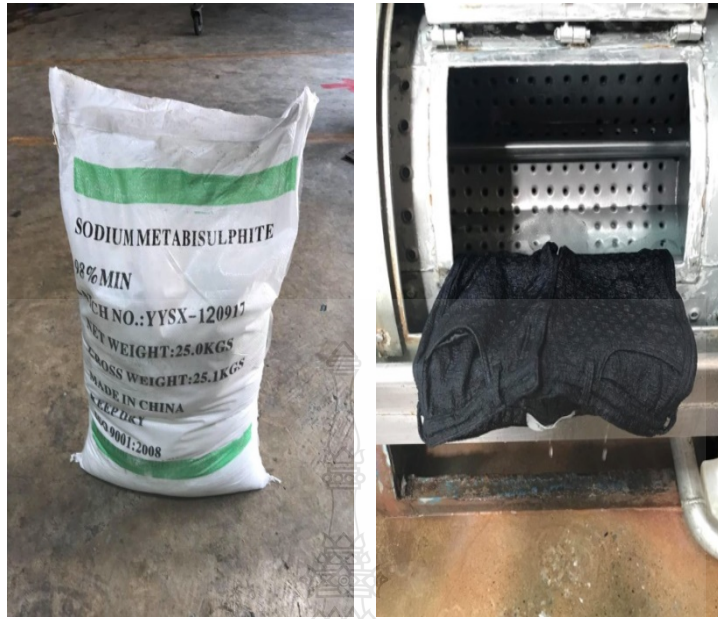
รูปที่ ค.3 ล้างผ้าด้วยสารโซเดียมไฮโดรซัลไฟต์
