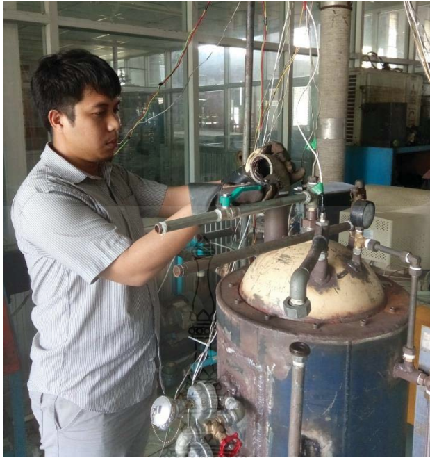
รูปที่ ข. 13 ติดตั้งท่อไอเสียและท่อไอน้ำ
