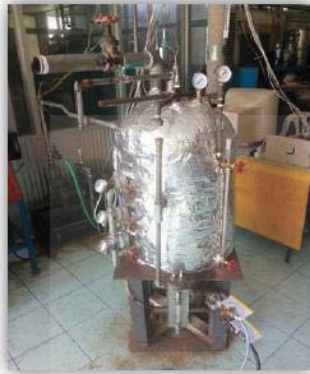
รูปที่ 1 หม้อไอน้ำแบบที่มีการเผาไหม้และระเหยภายใต้วัสดุพอร์นโดยไม่มี การสูญเสียความร้อนจากไอเสีย
