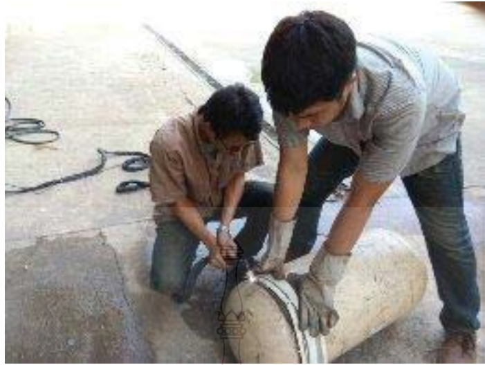
รูปที่ ข.1 การตัดถัง NGV ใช้ทำผนังห้องเผาไหม้
