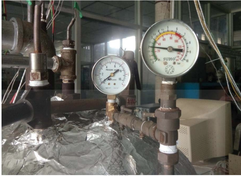
รูปที่ ข. 19 Pressure gauge ของห้องเก็บไอน้ำและห้องเผาไหม้
