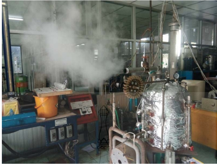
รูปที่ ข. 17 ไอ้่น้ำผสมกับไอเสีย ที่ได้จากการเดินเครื่องหม้อไอน้่น้ำ
