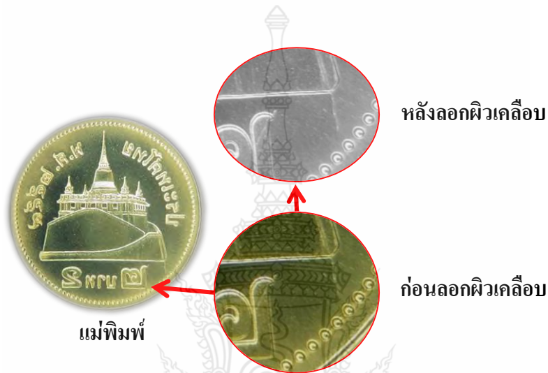
รูปที่ 4.14 รอยแตกร้าวของวัสดุแม่พิมพ์ K490 ที่เคลือบผิว TiN บริเวณเลขสอง
