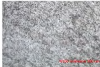
ภาพที่ 17 W360 สภาพหลังอบคินไฟ Nitric 5%(50X)
