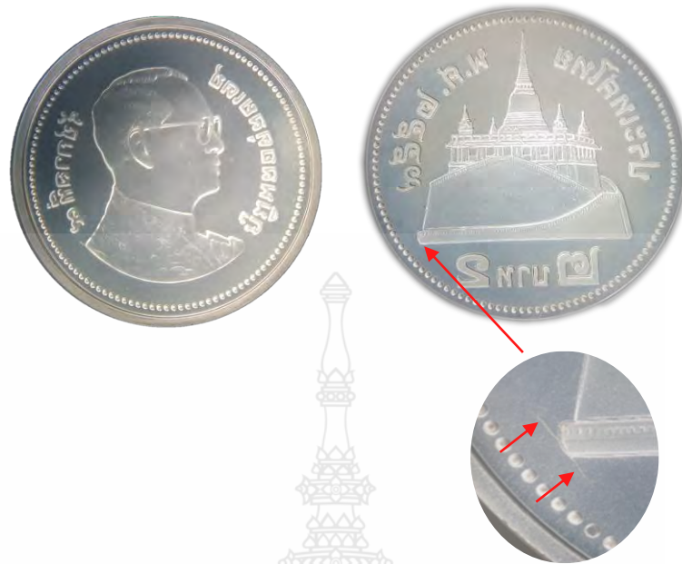
รูปที่ ก.15 ความเสียหายของวัสดุแม่พิมพ์ KD21 ที่เคลือบผิวด้วยสารเคลือบ CrN (ตัวอย่างทดลองที่ 4)
