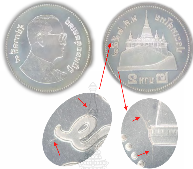
รูปที่ ก.13 ความเสียหายของวัสดุแม่พิมพ์ KD21 ที่เคลือบผิวด้วยสารเคลือบ CrN (ตัวอย่างทดลองที่ 2)
