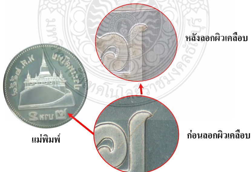
รูปที่ 4.15 รอยแตกร้าวของวัสดุแม่พิมพ์ K490 ที่เคลือบผิว CrN บริเวณเลขสอง
