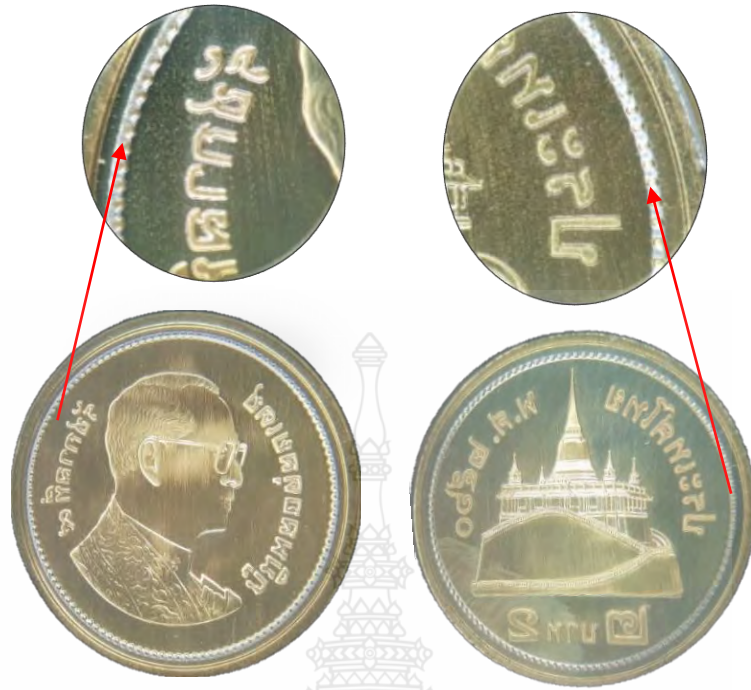
รูปที่ ก.27 ความเสียหายของวัสดุแม่พิมพ์ W360 ที่เคลือบผิวด้วยสารเคลือบ TiN (ตัวอย่างทดลองที่ 1)
