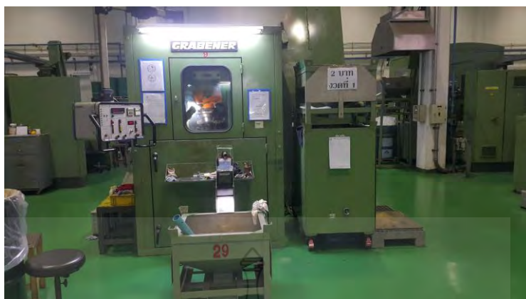
รูปที่ 3.11 ภาพการปั๊มขึ้นรูปเหรียญ 2 บาท
