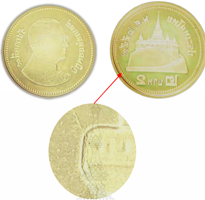
รูปที่ ก.9 ความเสียหายของวัสดุแม่พิมพ์ KD21 ที่เคลือบผิวด้วยสารเคลือบ TiN (ตัวอย่างทดลองที่ 3)
