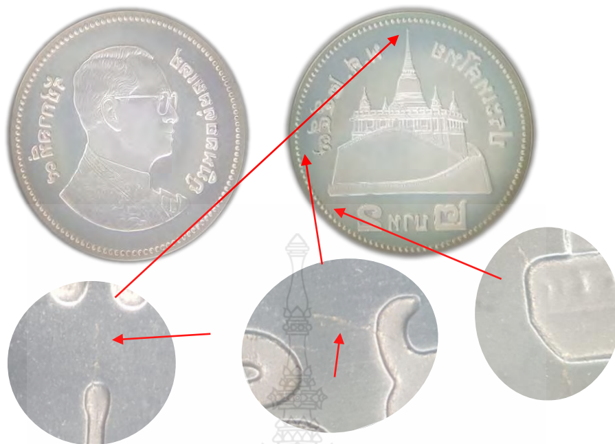
รูปที่ ก.23 ความเสียหายของวัสดุแม่พิมพ์ K490 ที่เคลือบผิวด้วยสารเคลือบ CrN (ตัวอย่างทดลองที่ 2)
