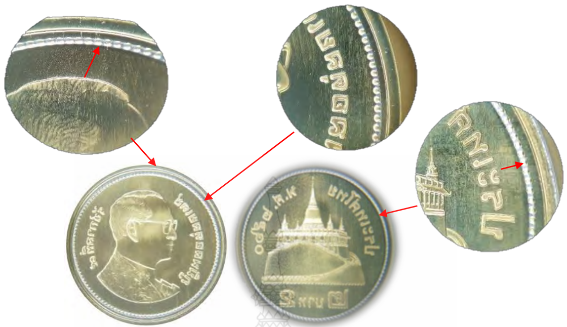
รูปที่ ก.29 ความเสียหายของวัสดุแม่พิมพ์ W360 ที่เคลือบผิวด้วยสารเคลือบ TiN (ตัวอย่างทดลองที่ 3)
