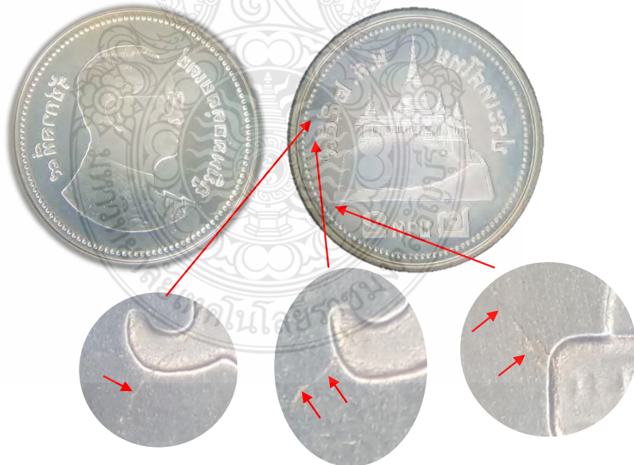
รูปที่ ก.16 ความเสียหายของวัสดุแม่พิมพ์ KD21 ที่เคลือบผิวด้วยสารเคลือบ CrN (ตัวอย่างทดลองที่ 5)
