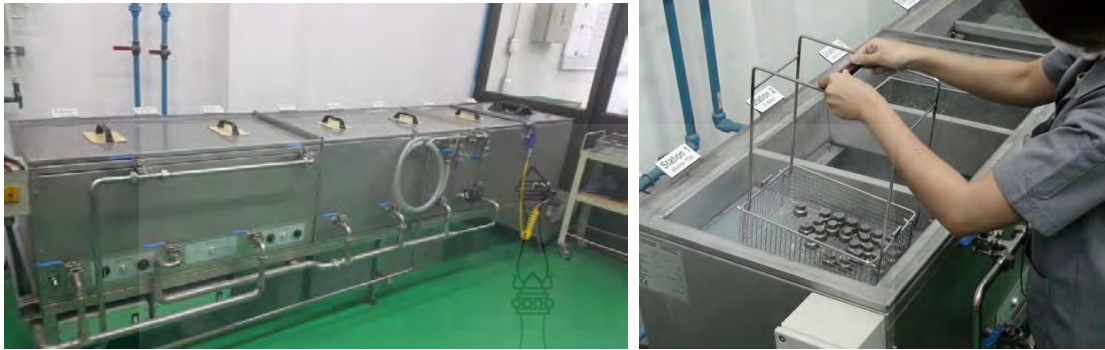
รูปที่ 3.7 รูปแม่พิมพ์ปั๊มขึ้นรูปเหรียญ 2 บาทที่ล้างทำความสะอาดด้วยเครื่องอัลตราโซนิค
