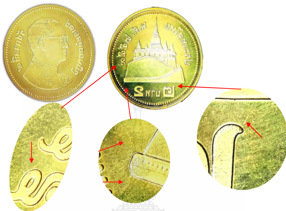
รูปที่ ก.7 ความเสียหายของวัสดุแม่พิมพ์ KD21 ที่เคลือบผิวด้วยสารเคลือบ TiN (ตัวอย่างทดลองที่ 1)
