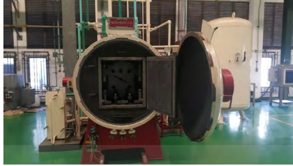
รูปที่ 3.4 รูปเตาอบชุบแข็งที่ใช้ในการชุบแม่พิมพ์ปั๊มขึ้นรูปเหรียญ (Hardening furnace)
