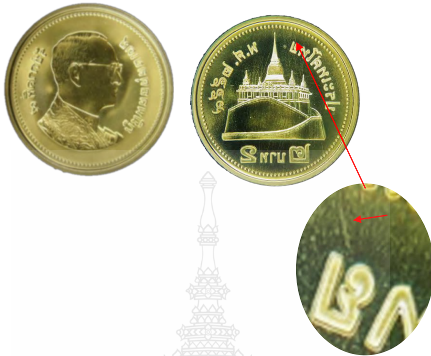
รูปที่ ก.19 ความเสียหายของวัสดุแม่พิมพ์ K490 ที่เคลือบผิวด้วยสารเคลือบ TiN (ตัวอย่างทดลองที่ 3)
