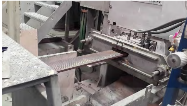
รูปที่ 2.28 แผ่น โลหะถูกดึงจาก Die (Strips exiting Graphite dies)
