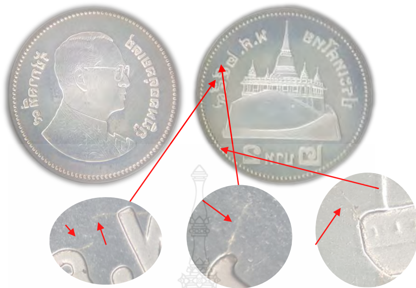
รูปที่ ก.25 ความเสียหายของวัสดุแม่พิมพ์ K490 ที่เคลือบผิวด้วยสารเคลือบ CrN (ตัวอย่างทดลองที่ 4)
