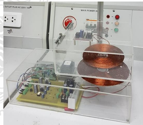
รูปที่ 4 ต้นแบบระบบการโอนย้ายพลังงานแบบไร้สาย
