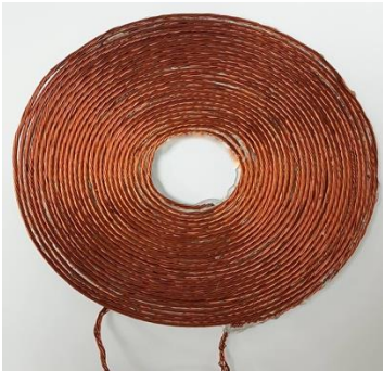
รูปที่ 5 การพันขดลวดตัวส่งและขดลวดตัวรับ
