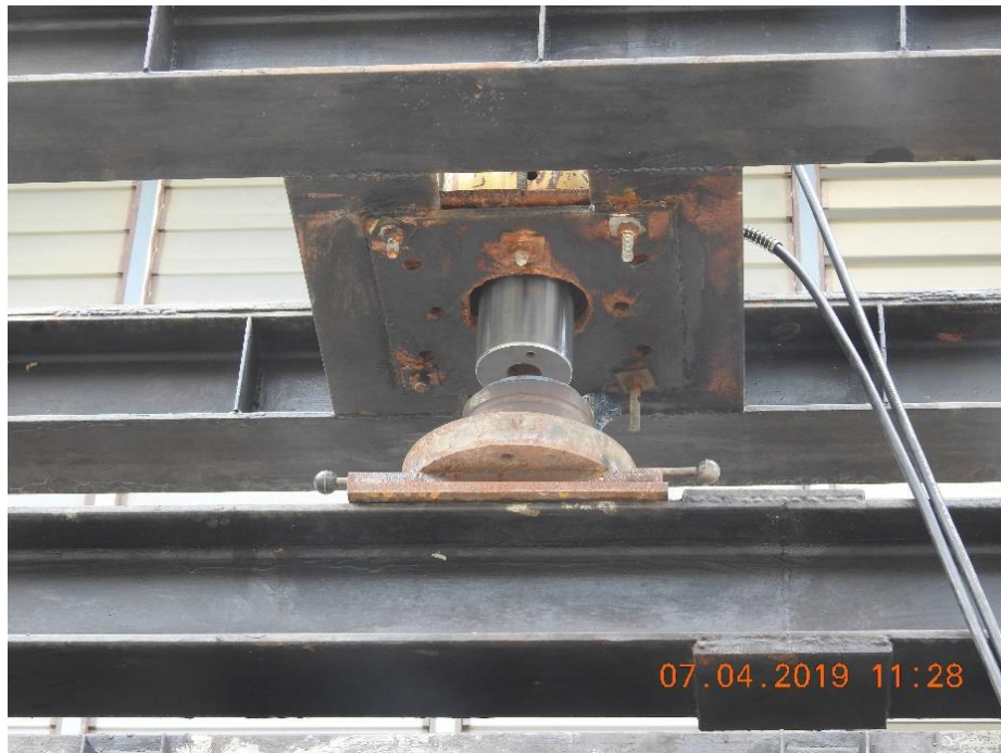
รูปที่ ก.5 แม่แรงไฮดรอลิคสำหรับการให้แรงกระทำในแนวดิ่ง
