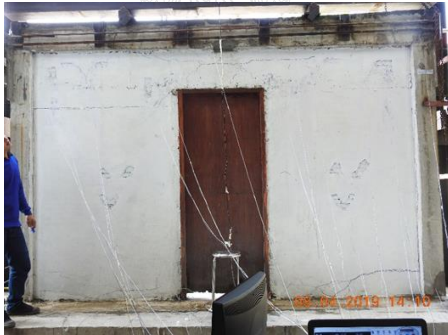
รูปที่ ข.4 การทดสอบ W ระยะการเคลื่อนตัวที่ 15 มิลลิเมตร
