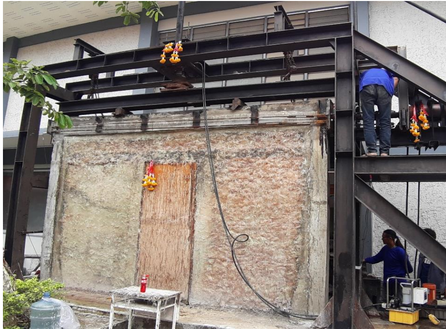
รูปที่ 3.17 ผนังอิฐก่อสำหรับการทดสอบ W-G
