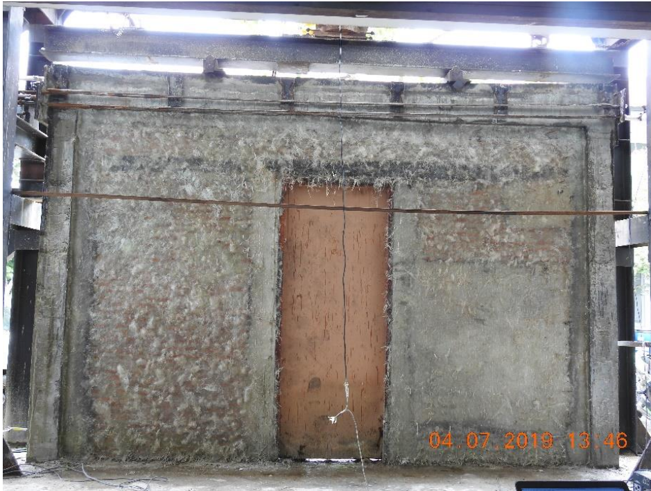
รูปที่ ข.17 การทดสอบ W-G ระยะการเคลื่อนตัวที่ 10 มิลลิเมตร
