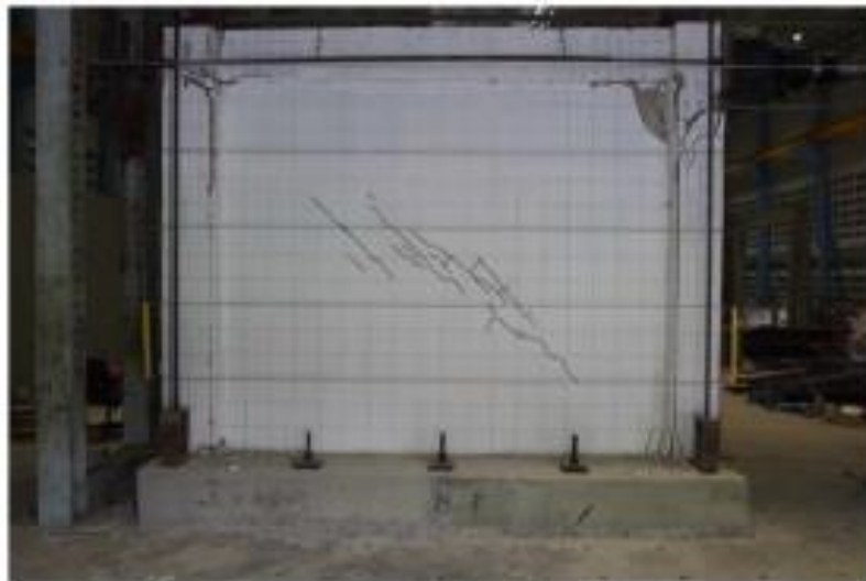
รูปที่ 2.3 ความเสียหายของผนังอิฐก่อที่ไม่ได้ทำการเสริมกำลัง และผนังอิฐก่อที่ทำการเสริมกำลังด้วยวิธี Ferrocement
