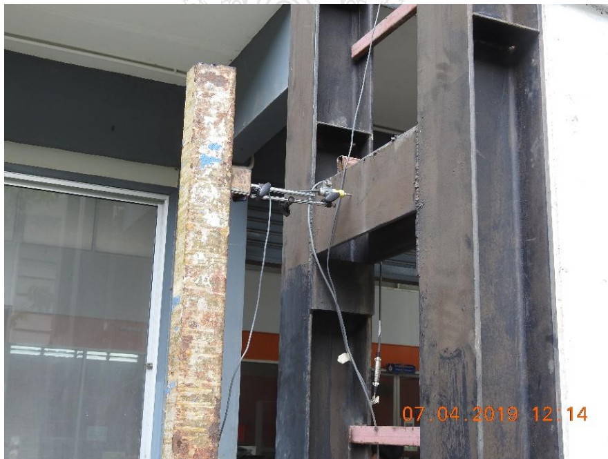
รูปที่ ก.10 เครื่องมือวัดการเคลื่อนที่ของตัวอย่างทดสอบ LVDT #4
