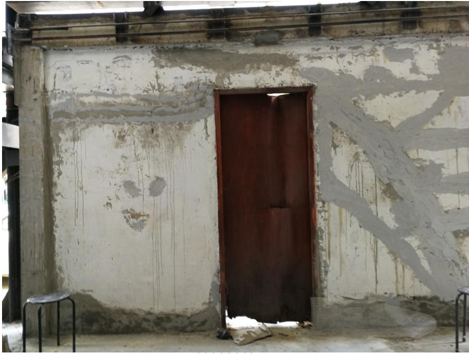
รูปที่ 3.13 การซ่อมแซมผนังอิฐก่อเพื่อเตรียมการทดสอบ W-RG
