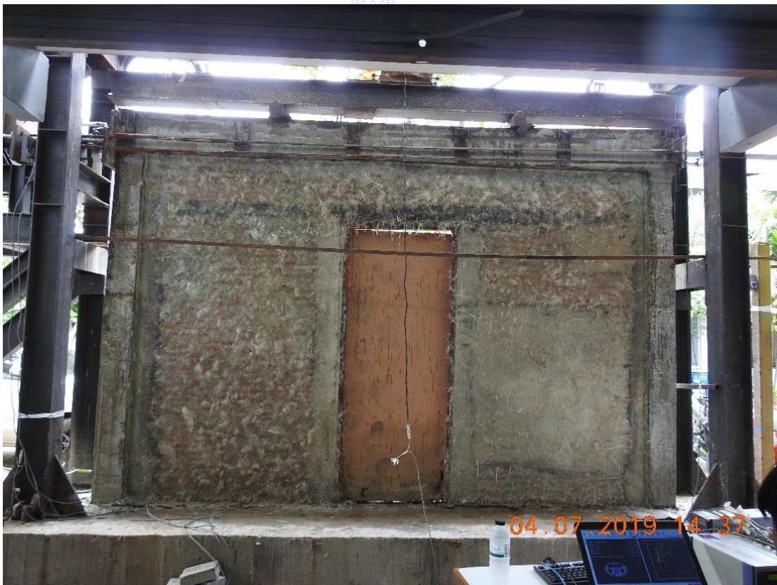
รูปที่ 4.5 ผนังอิฐก่อตัวอย่างภายหลังการทดสอบ W-G
