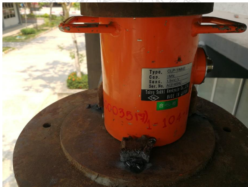
รูปที่ ก.2 เซลล์วัดแรงสำหรับวัดแรงที่กระทำด้านข้าง
