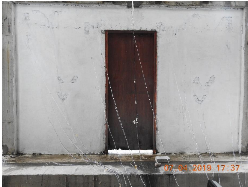
รูปที่ ข.1 การทดสอบ W ระยะการเคลื่อนตัวที่ 2.5 มิลลิเมตร
