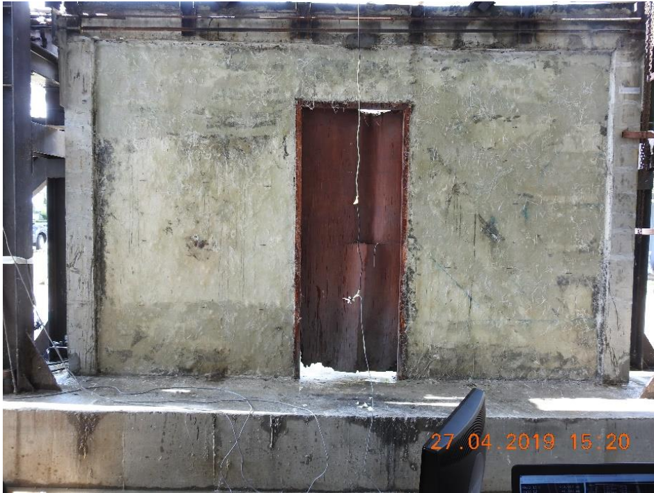
รูปที่ -10 การทดสอบ W-RG ระยะการเคลื่อนตัวที่ 10 มิลลิเมตร
