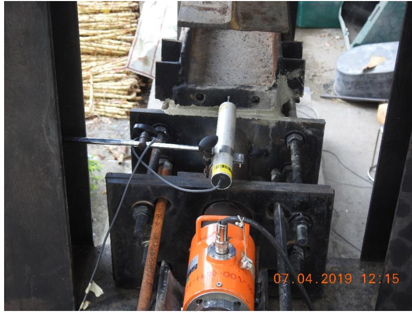
รูปที่ ก.11 เครื่องมือวัดการเคลื่อนที่ของตัวอย่างทดสอบ LVDT #1
