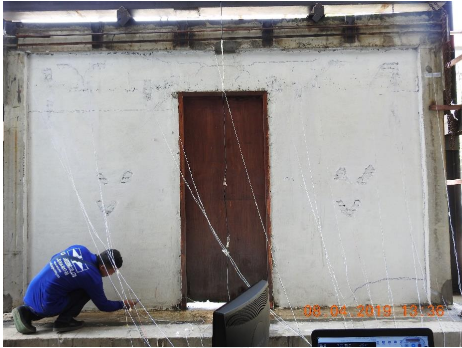
รูปที่ ข.3 การทดสอบ W ระยะการเคลื่อนตัวที่ 10 มิลลิเมตร
