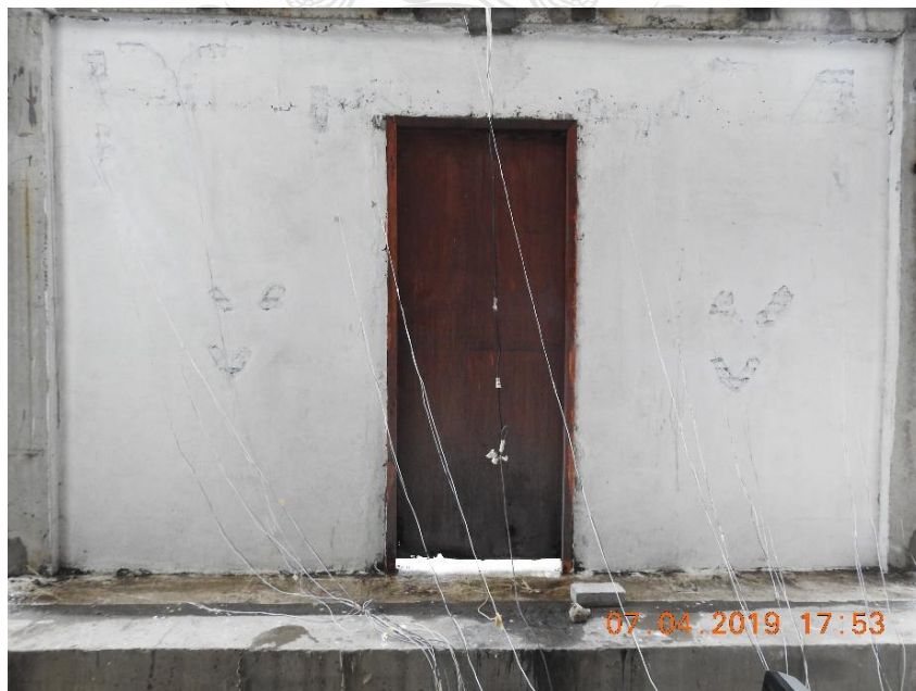
รูปที่ ข.2 การทดสอบ W ระยะการเคลื่อนตัวที่ 5 มิลลิเมตร
