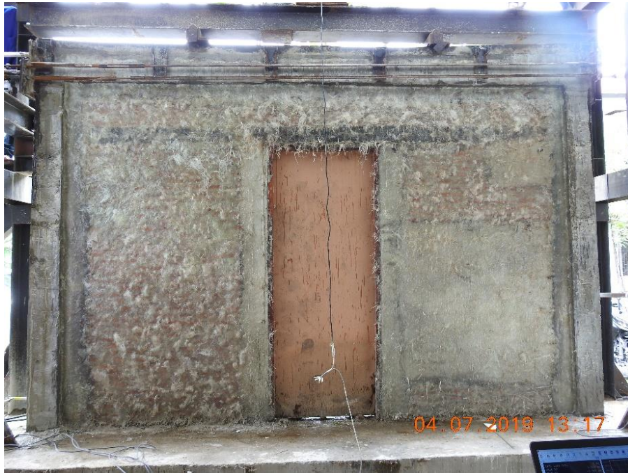
รูปที่ ข.15 การทดสอบ W-G ระยะการเคลื่อนตัวที่ 2.5 มิลลิเมตร
