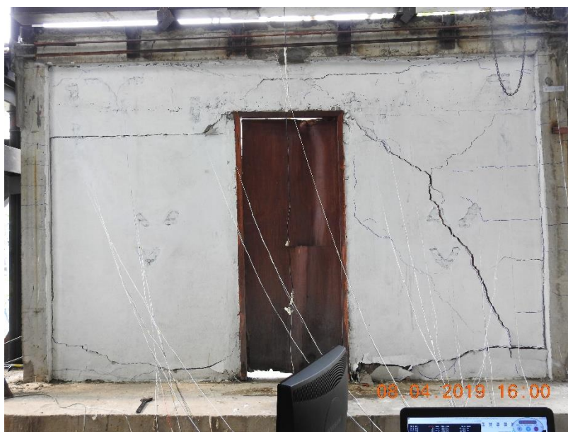
รูปที่ ข.7 1 การทดสอบ W ระยะการเคลื่อนตัวที่ 30 มิลลิเมตร
