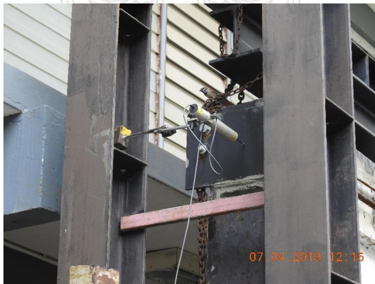
รูปที่ ก.8 เครื่องมือวัดการเคลื่อนที่ของตัวอย่างทดสอบ LVDT #3
