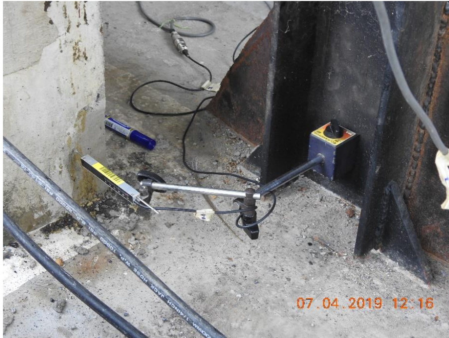
รูปที่ ก.9 เครื่องมือวัดการเคลื่อนที่ของตัวอย่างทดสอบ LVDT #2
