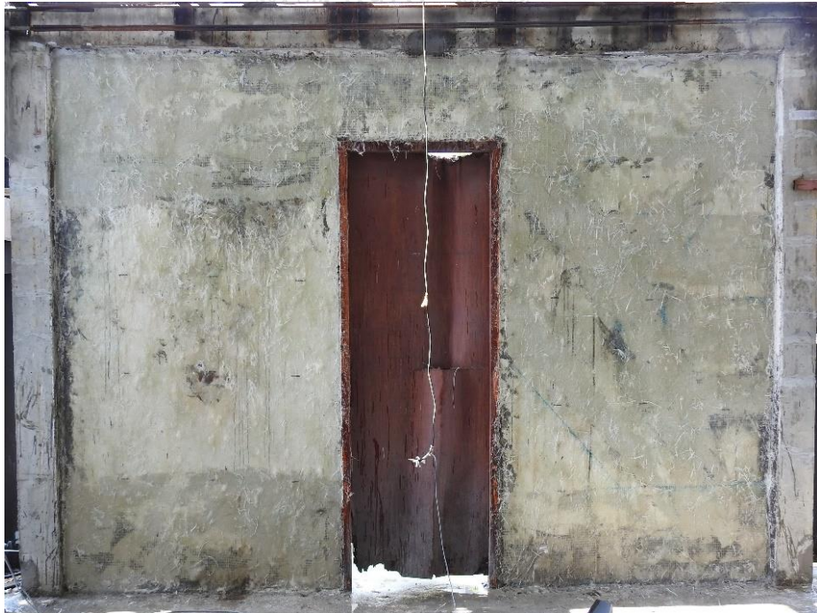
รูปที่ 3.16 ผนังอิฐก่อสำหรับการทดสอบ W-RG
