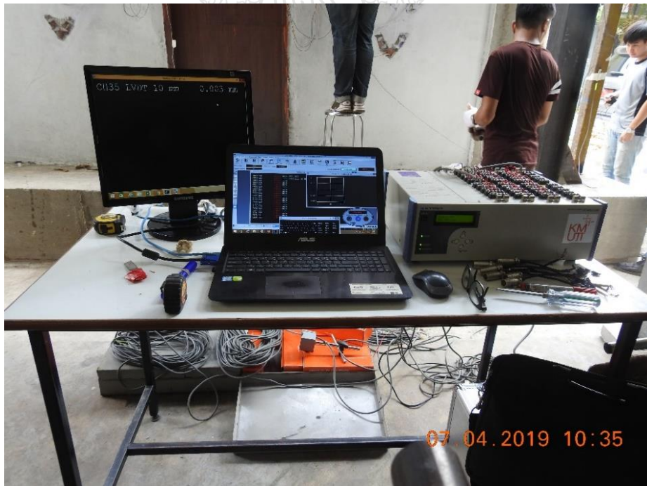
รูปที่ 3.10 เครื่องมือบันทึกข้อมูลการทดสอบ (Data Logger)
