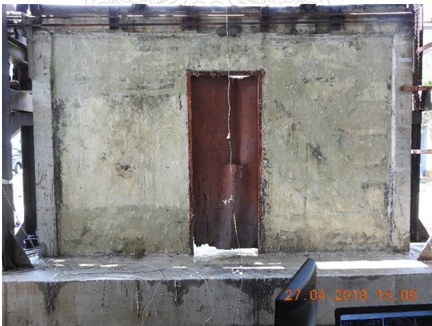
รูปที่ ข.9 การทดสอบ W-RG ระยะการเคลื่อนตัวที่ 5 มิลลิเมตร
