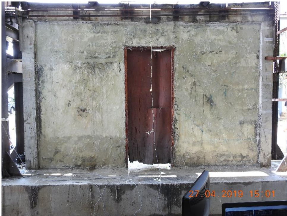
รูปที่ 3.6 ผนังตัวอย่างสำหรับการทดสอบ W-RG
