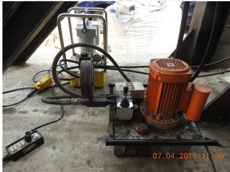
รูปที่ ก.4 ปุ่มไฟฟ้าสำหรับให้แรงกระทำกับแม่แรงไฮดรอลิก
