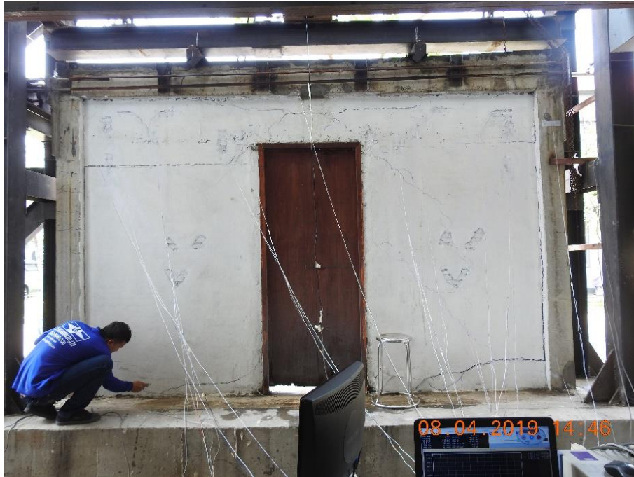
รูปที่ ข.5 การทดสอบ W ระยะการเคลื่อนตัวที่ 20 มิลลิเมตร
