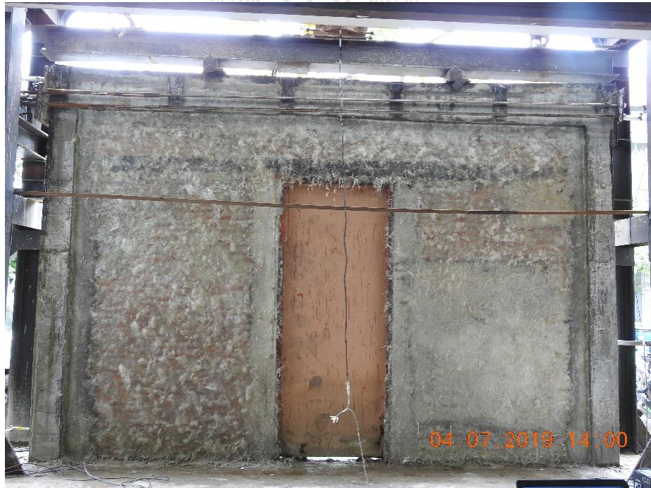
รูปที่ ข.18 การทดสอบ W-G ระยะการเคลื่อนตัวที่ 15 มิลลิเมตร
