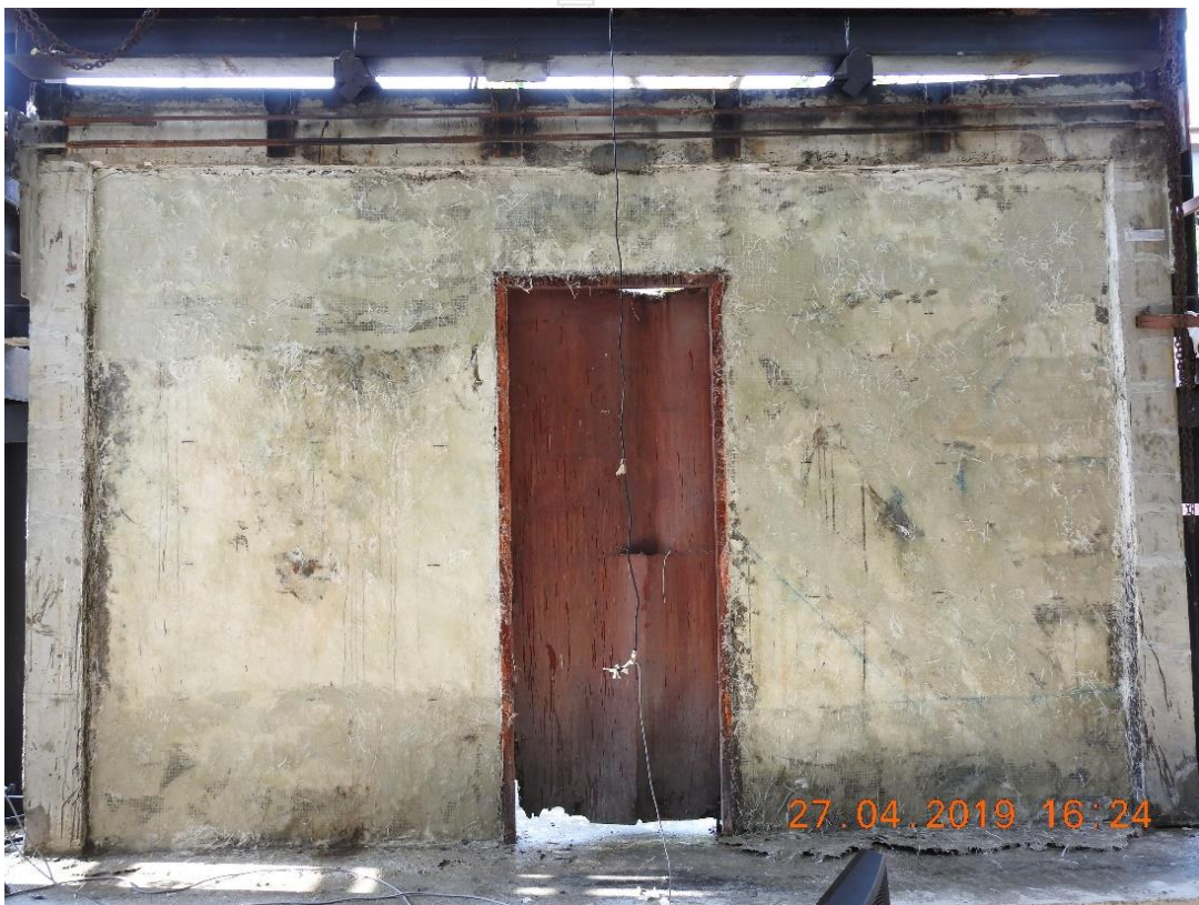
รูปที่ 4.3 ผนังอิฐก่อตัวอย่างภายหลังการทดสอบ W-RG
