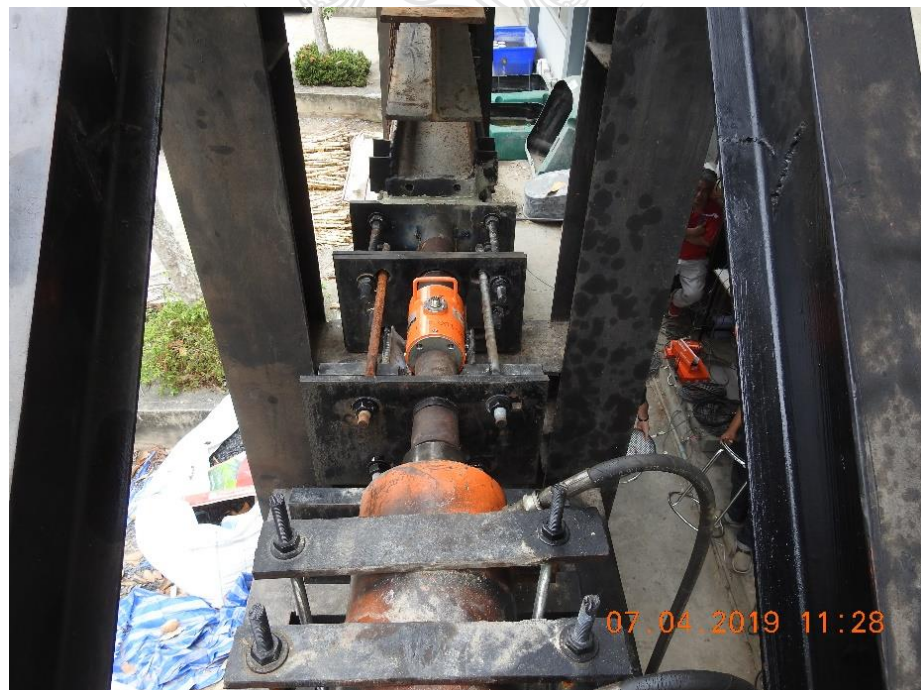
รูปที่ ก.6 แม่แรงไฮดรอลิคสำหรับการให้แรงกระทำด้านข้าง
