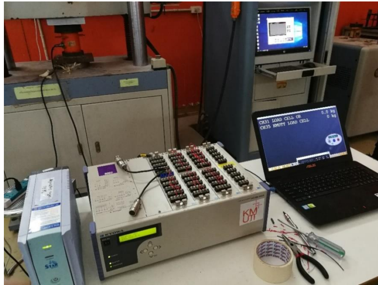
รูปที่ ก.3 การสอบเทียบเครื่องมือเซลล์วัดแรง
