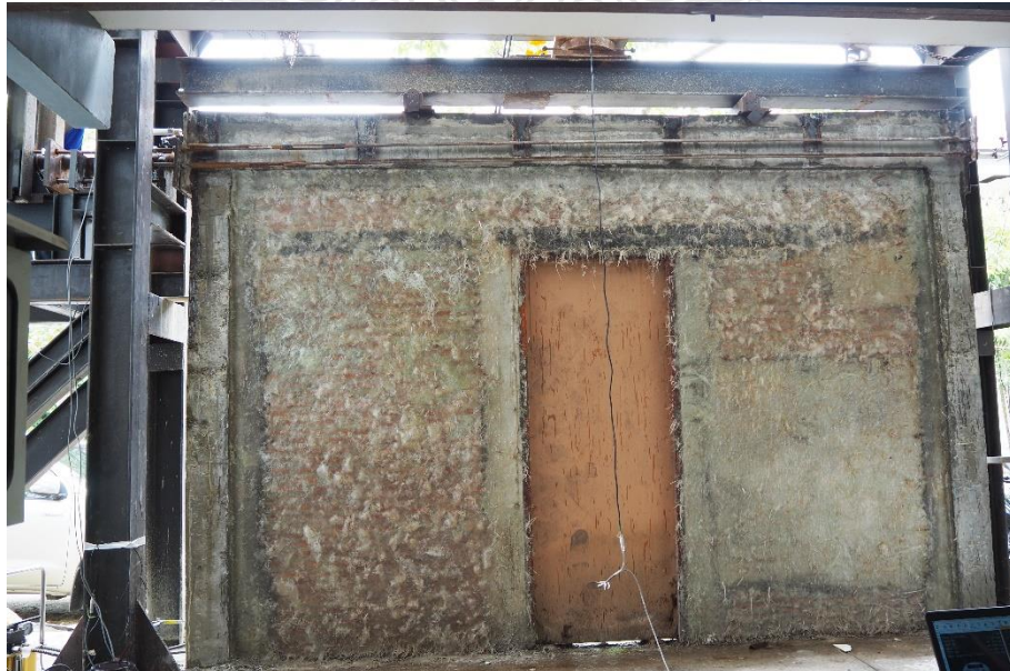
รูปที่ ข.16 การทดสอบ W-G ระยะการเคลื่อนตัวที่ 5 มิลลิเมตร
