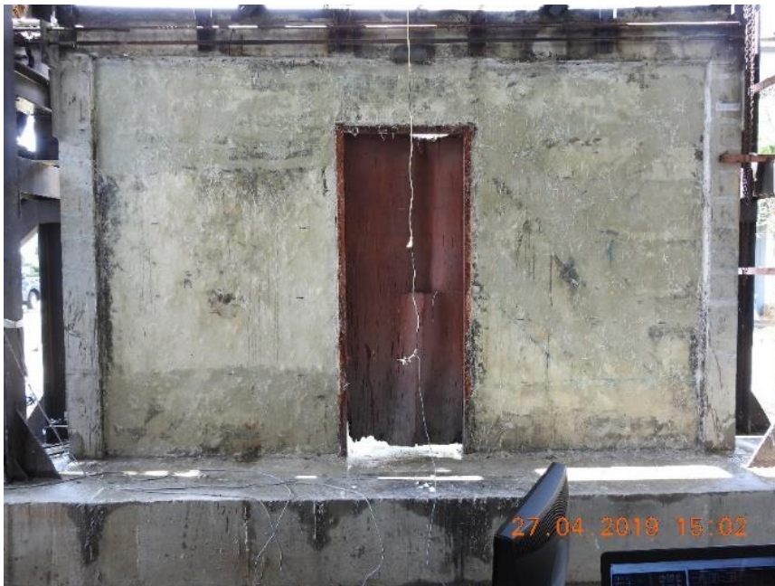
รูปที่ ข.8 การทดสอบ W-RG ระยะการเคลื่อนตัวที่ 2.5 มิลลิเมตร
