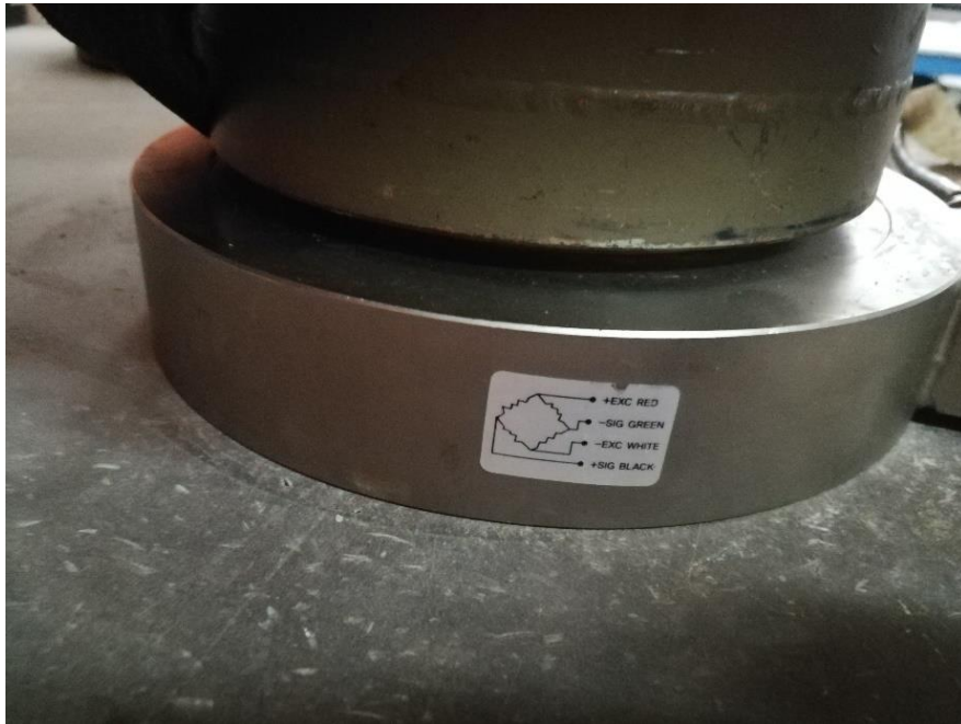
รูปที่ ก.1 เซลล์วัดแรงสำหรับวัดแรงที่กระทำในแนวตั้ง
