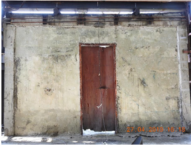
รูปที่ ข.14 การทดสอบ W-RG ระยะการเคลื่อนตัวที่ 30 มิลลิเมตร
