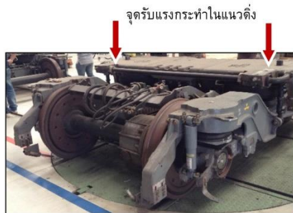
รูปที่ 4 ตำแหน่งแรงกระทำต่อโบกี้รถไฟฟ้านเมือง (บริษัท รถไฟฟ้า ร.ฟ.ท จำกัด, 2558)
