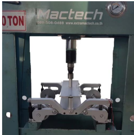
รูปที่ 3.17 นำรถไฟจำลองเข้าเครื่องอัดไฮดรอลิก
