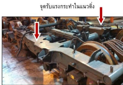
รูปที่ 5 ตำแหน่งแรงกระทำต่อโบกี้รถไฟฟ้านเมือง (บริษัท รถไฟฟ้ากรุงเทพ จำกัด (มหาชน), 2558)
