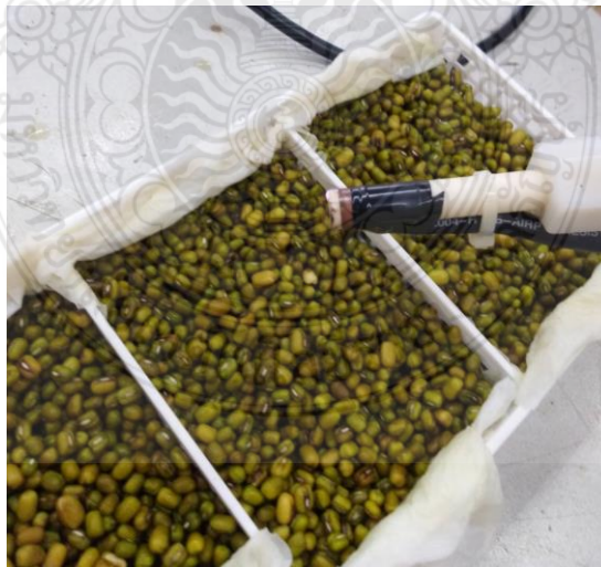
รูปที่ 4.10 การพ่นพลาสมาจริงบนถั่วเขียวด้วยแต่ละวิธี
