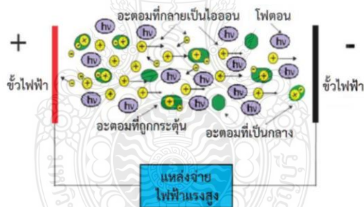
รูปที่ 2.22 การกำเนิดพลาสมาด้วยไฟฟ้าแรงสูง [11]
