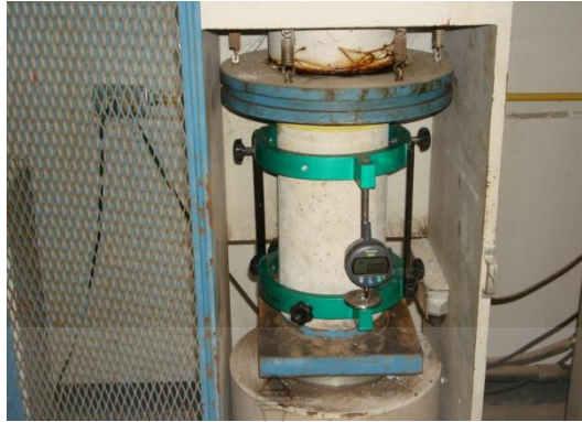
รูปที่ 3.12 การติดตั้งเครื่องทดสอบโมดูลัสยืดหยุ่นของคอนกรีตตามมาตรฐาน ASTM C 469
