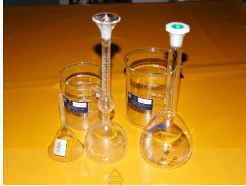
รูปที่ 3.6 ขวดมาตรฐานเลอชาเตอร์ลิเยร์ (Le Chatelier Flask)
